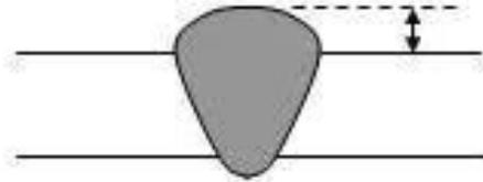
**Figura 2. 17 Sobremonta excesiva**
