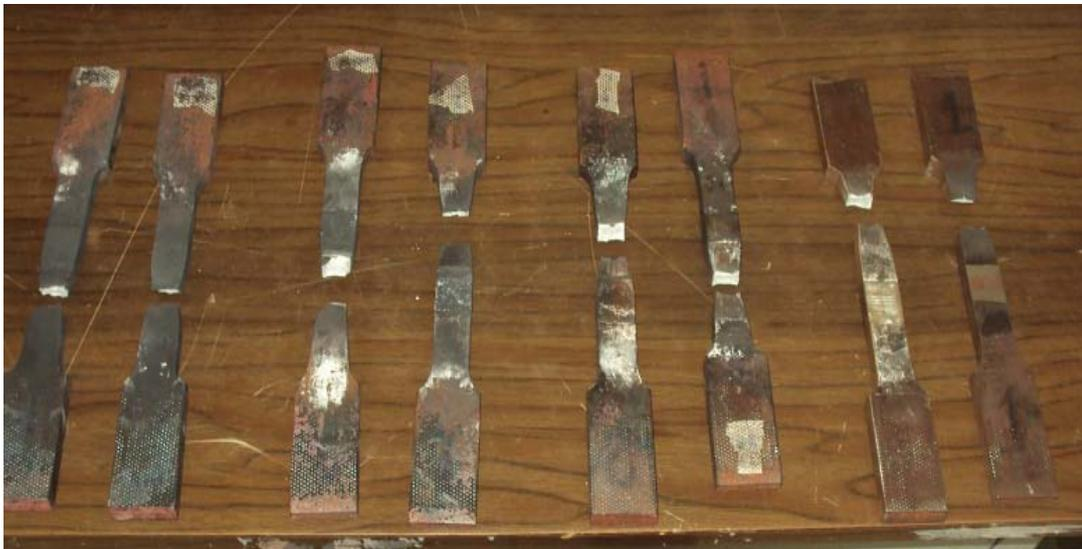
**C.2** Probetas con material base y material de aporte
