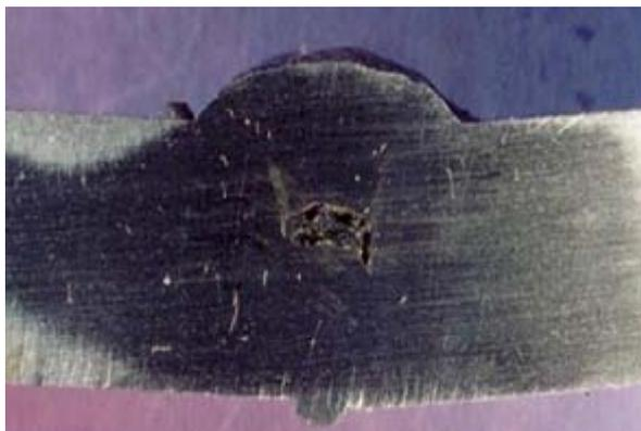
**Figura 2. 11 Penetración incompleta**
