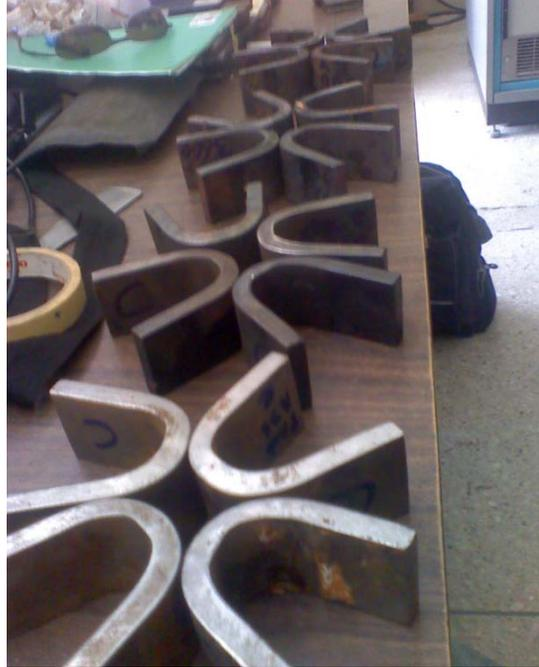
**F.1** Probetas de acero A 36 y Electrodo E 71T 1
