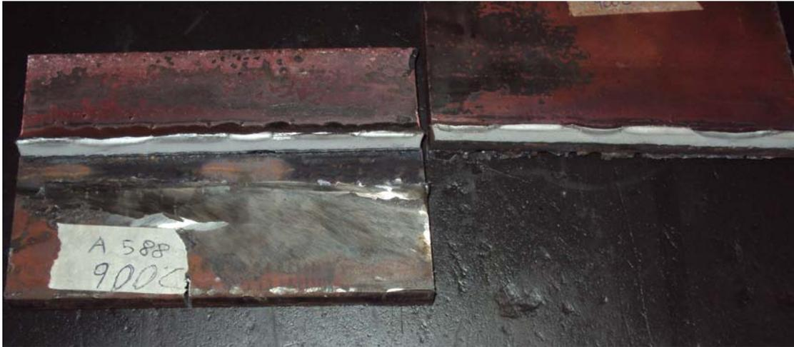
**G.3** Rotura en probetas de acero A588
