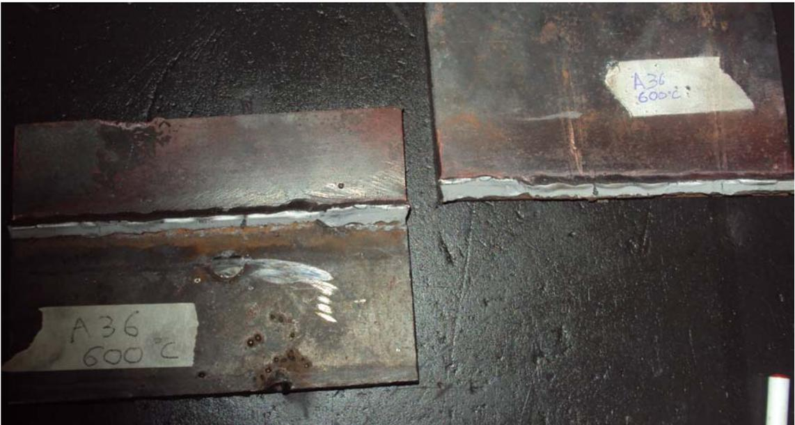
**G.2** Rotura en probetas de acero A36
