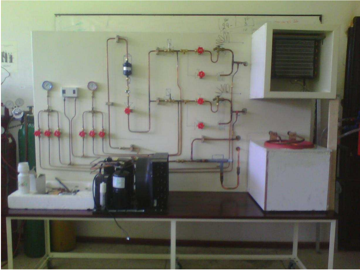
Fig. 6.5 Montaje de Tuberías y Accesorios.
