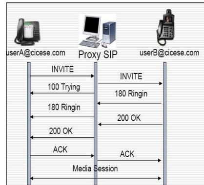
**Figura. 5. Establecimiento de una sesión de teléfono a teléfono SIP utilizando un Proxy**
