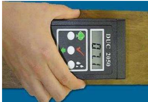
Figura 2. 28 Medidor eléctrico de Humedad (Primer método)
