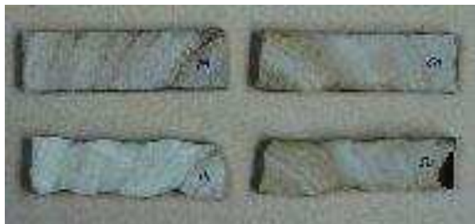
Figura 2. 48 Recuperación de colapso en Eucalyptus nitens
