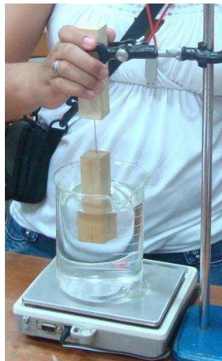
Figura 2. 29 Comparación del peso de la probeta de madera (Segundo método)
