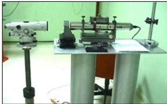
Figura. 5.5. Colimador óptico patrón de horizontalidad
