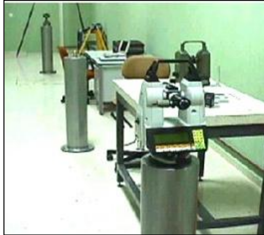
Figura. 5. 7. Hitos alineados para la determinación del error de cero
