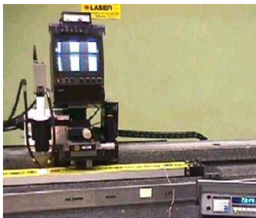
Figura. 5. 6. Calibración de miras de ínvar en banco interferométrico
