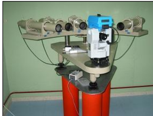
Figura. 5. 6. Teodolito enfrentado a conjunto de colimadores
