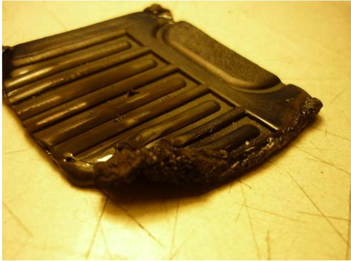
Foto 5.52 Ensayo a la llama PVC negro-se carboniza
