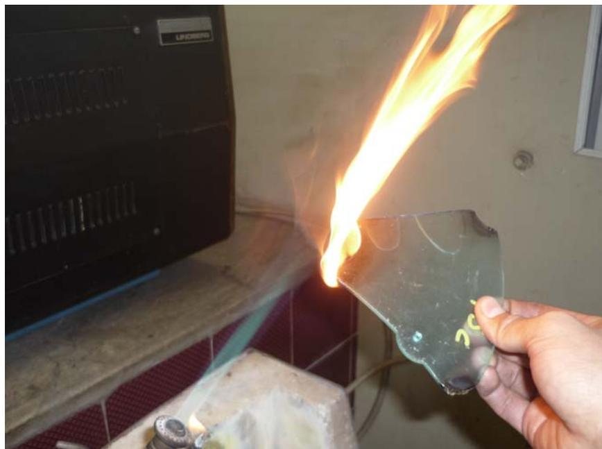
Foto 5.59 Ensayo a la llama PS cristal-llama amarilla
