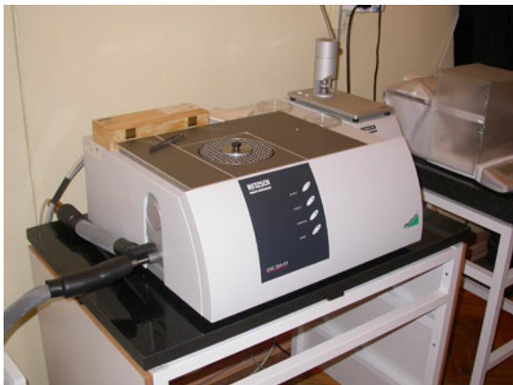
Foto 5.50 Calorímetro diferencial de barrido NETZSCH DSC 204 F1 Phoenix
