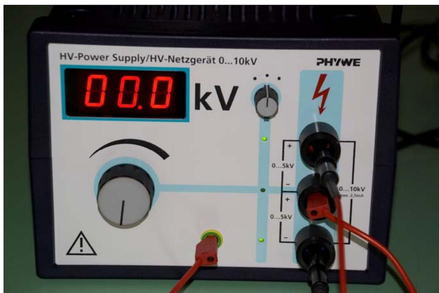
Foto 5.33 Fuente de corriente continua de 10Kv
