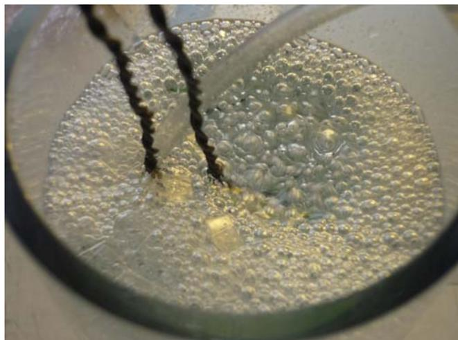
Foto 5.43 Flotabilidad en espuma de PET
