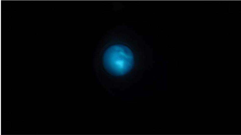
Foto 5.30 Visualización de luz a 20° a través del PVC
