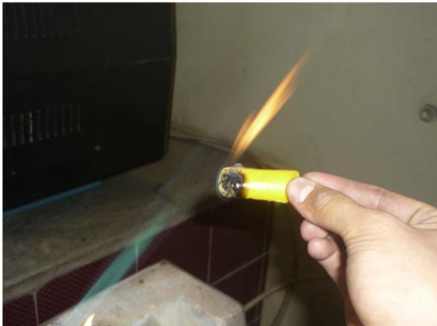
Foto 5.55 Ensayo a la llama PEAD amarillo-llama azul y produce goteo
