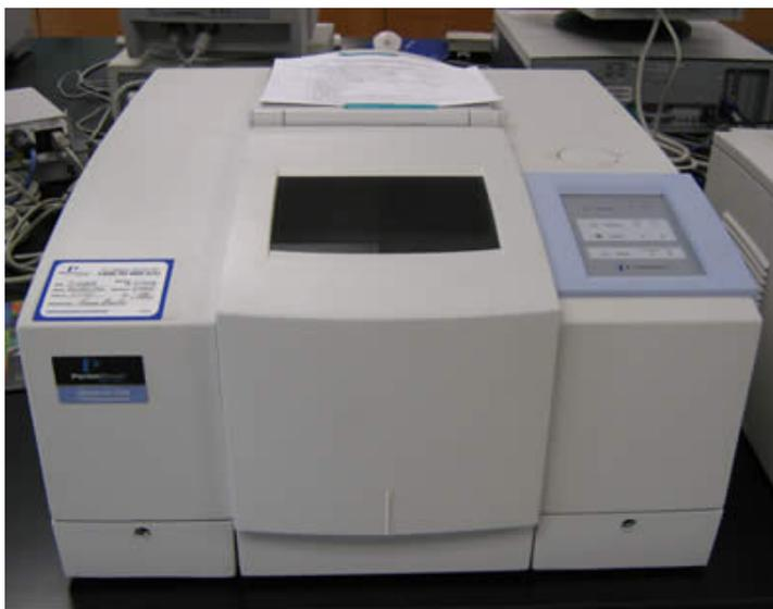
Foto 5.49 Espectrofotómetro FT-IR Perkin Elmer Spectrum One
