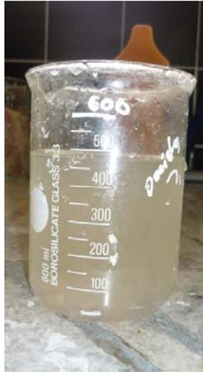
Foto 5.25 Hundimiento PVC transparente
