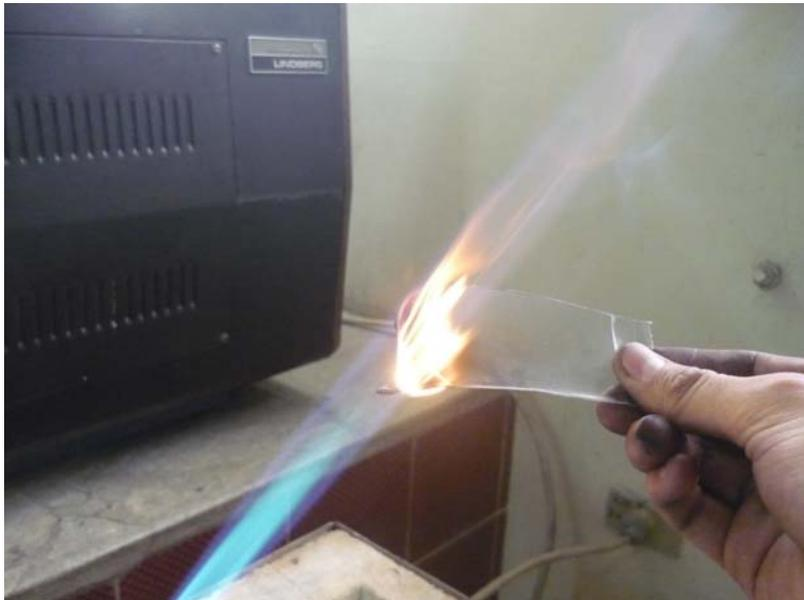
Foto 5.53 Ensayo a la llama PVC transparente-produce hollín
