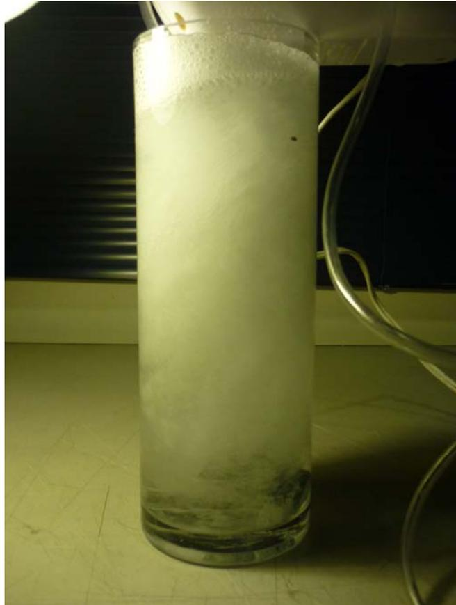
Foto 5.48 Celda de flotación con agitación constante
