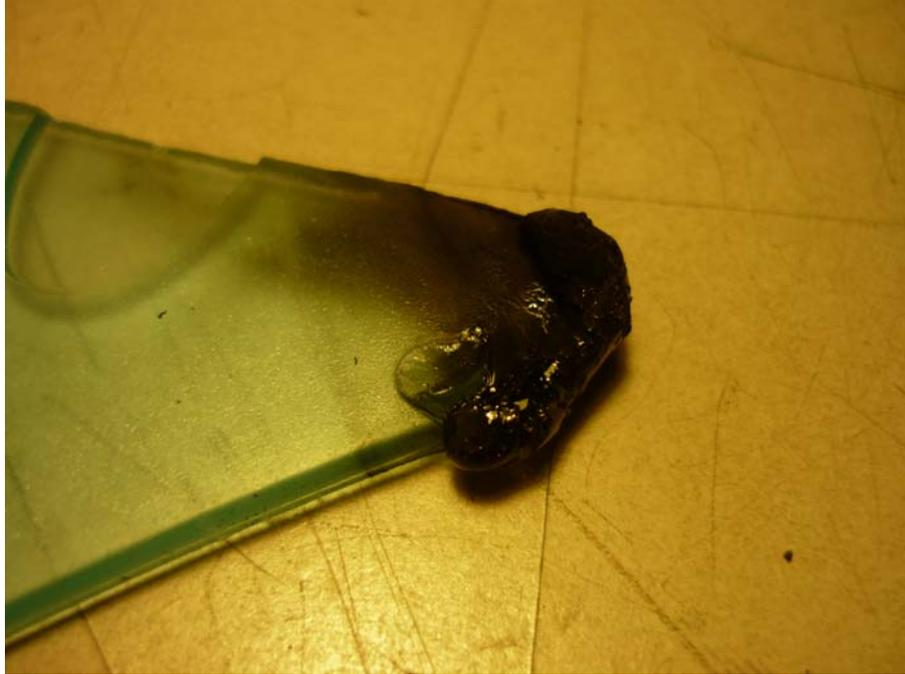
Foto 5.60 Ensayo a la llama PS cristal-se carboniza
