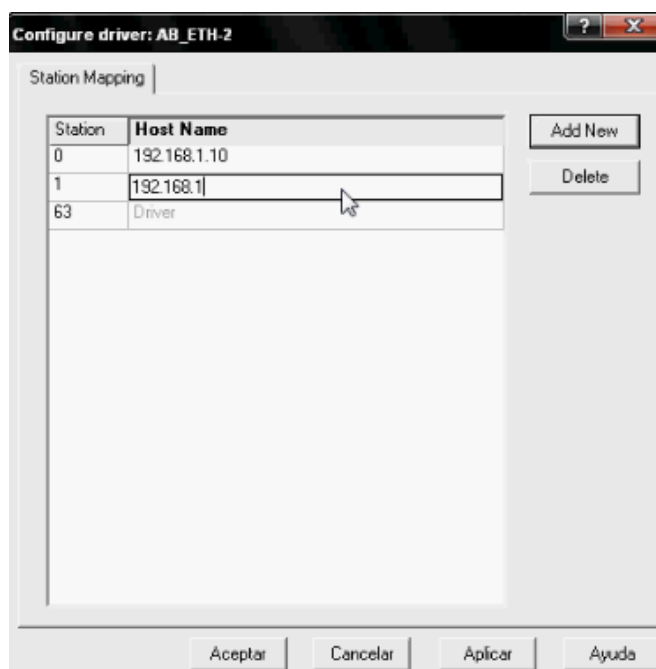
Figura 3.71 Pantalla de “Station Mapping” donde se ingresa las direcciones IP de los distintos controladores y del PC.
