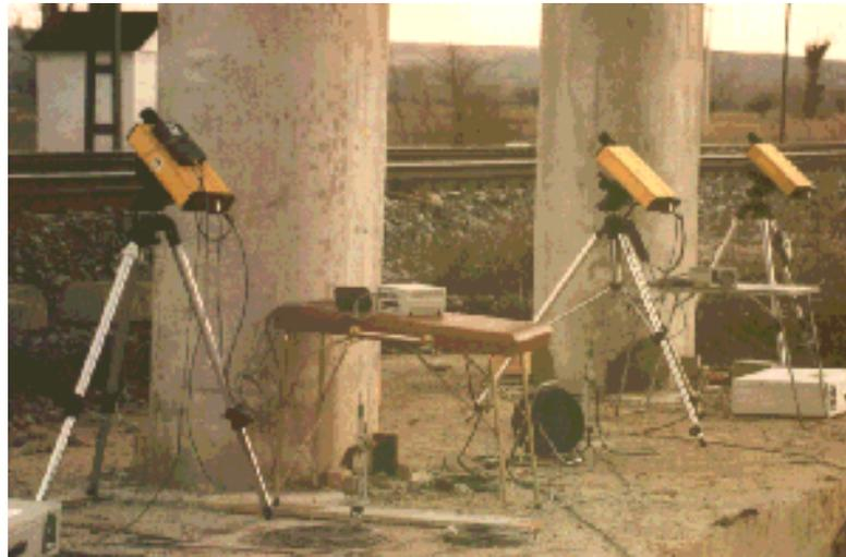
**Figura 6.3 Medidor láser para velocidades y desplazamientos.<sup>37</sup>**
