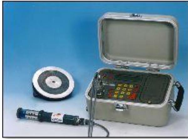
**Figura 6.2 Corrosímetro con su respectivo sensor.**<sup>36</sup>
