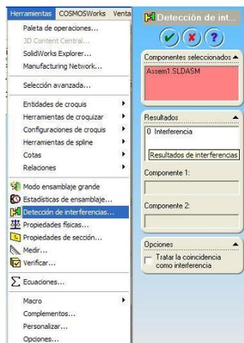
**Figura 3.16 Detección de interferencias del accesorio 1**
