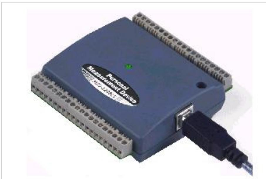
**Figura 4.5 Tarjeta de adquisición de datos PMD-1208LS**
