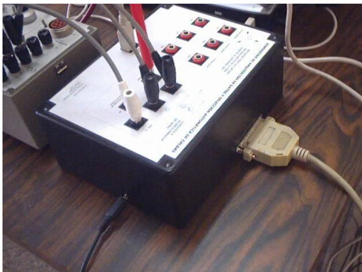
**Figura 4.16 Dispositivo de adquisición de datos y selección automática de galgas conectado**
