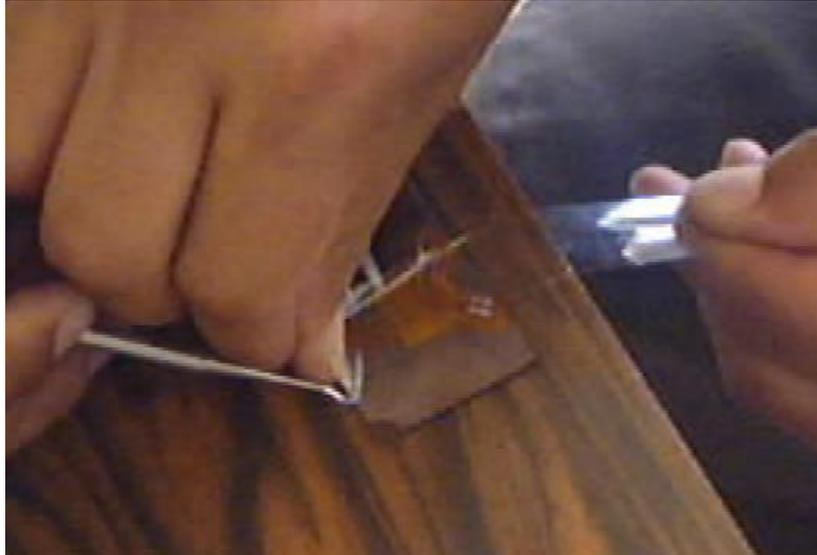
**Figura 3.71 Fijación de la roseta con la cinta adhesiva.**
