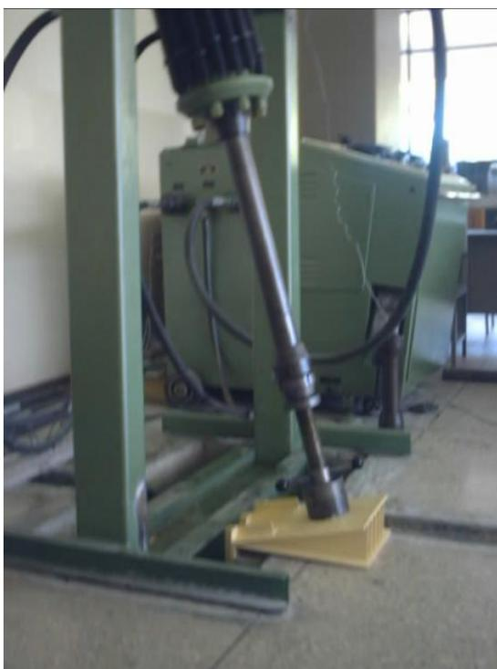
**Figura 3.57 El cilindro girado 15° asienta perfectamente sobre el accesorio**
