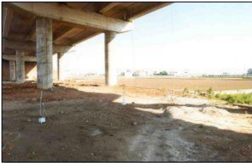
**Figura 6.4 Medición en un puente por medio de LVTD's.<sup>38</sup>**
