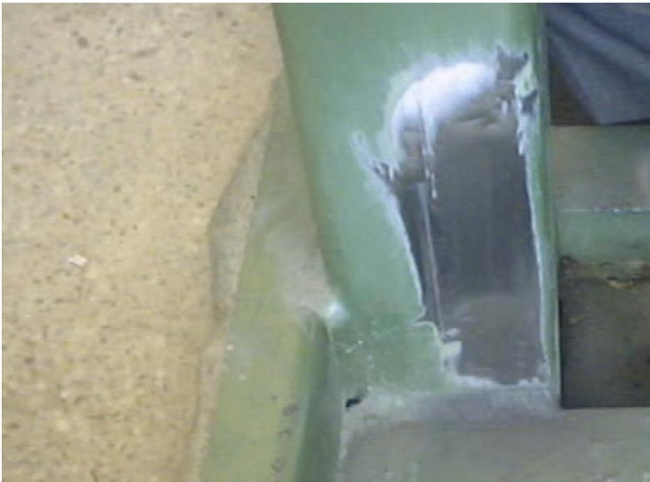
**Figura 3.66 Limpieza de la sección en donde se colocara la roseta.**
