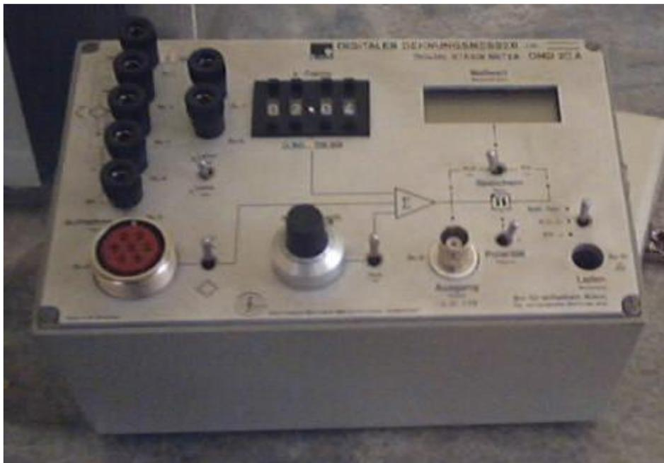
**Figura 4.4 Medidor de deformaciones unitarias.**
