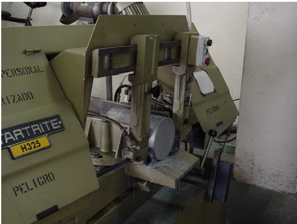
Figura 4-8 : Corte del tocho de aluminio de planchas según especificaciones de las normas (laboratorio de máquinas y herramientas CEMA).
