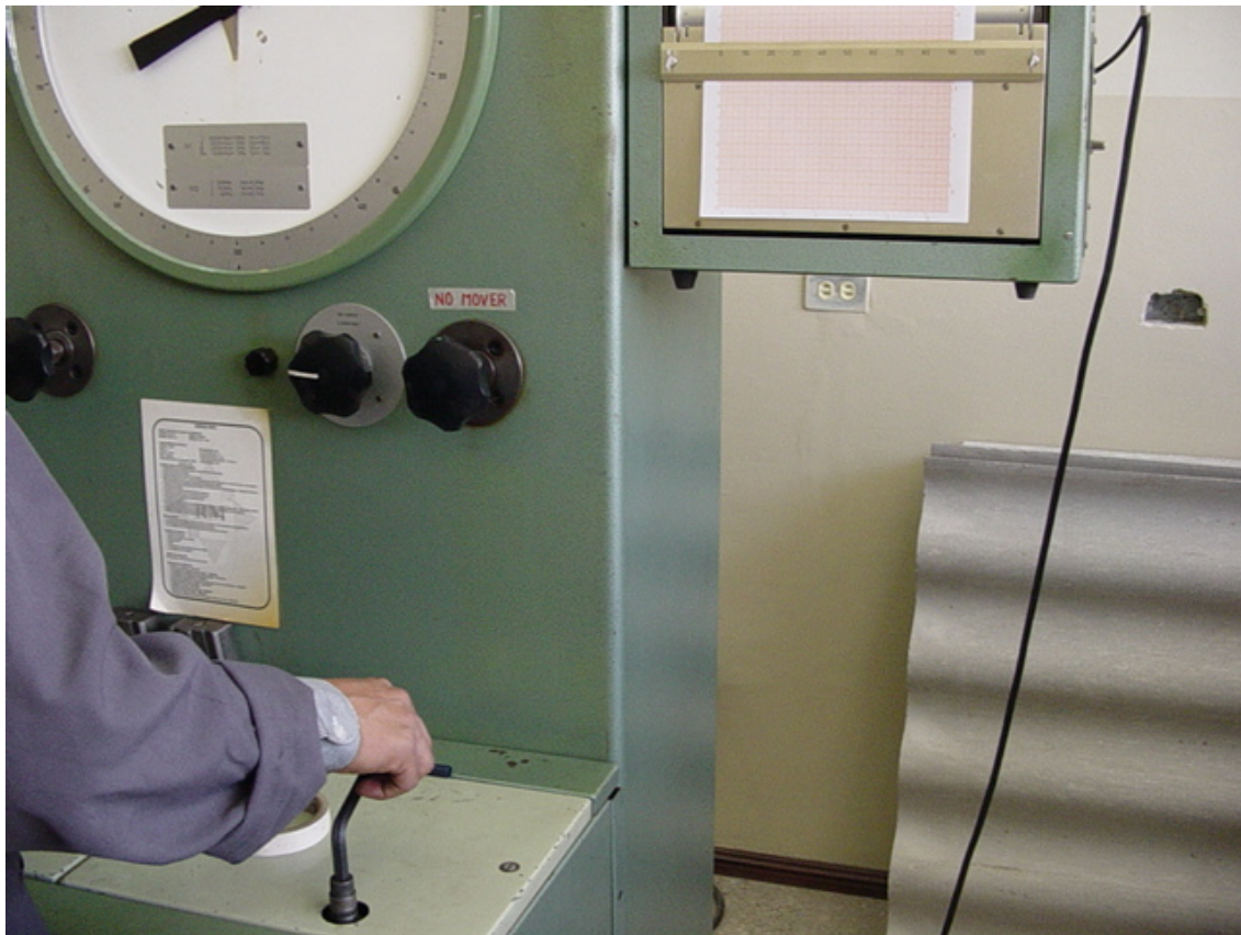
Figura 4-6 : Calibración de la máquina de ensayos universales (laboratorio de resistencia de materiales).
