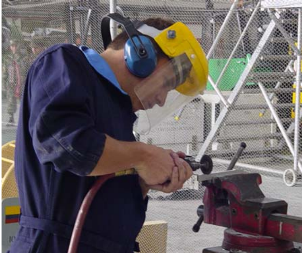
Figura 4-1 : Corte de las probetas utilizando la rápida (taller de estructuras CIDFAE)
