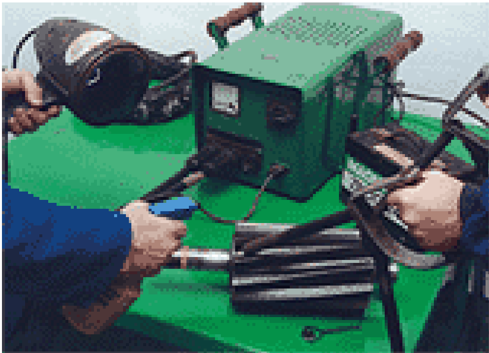
Figura 2-8 : Equipo para método de partículas magnéticas (fuente de poder, cables de conexión, terminales, bobina y lámpara).
