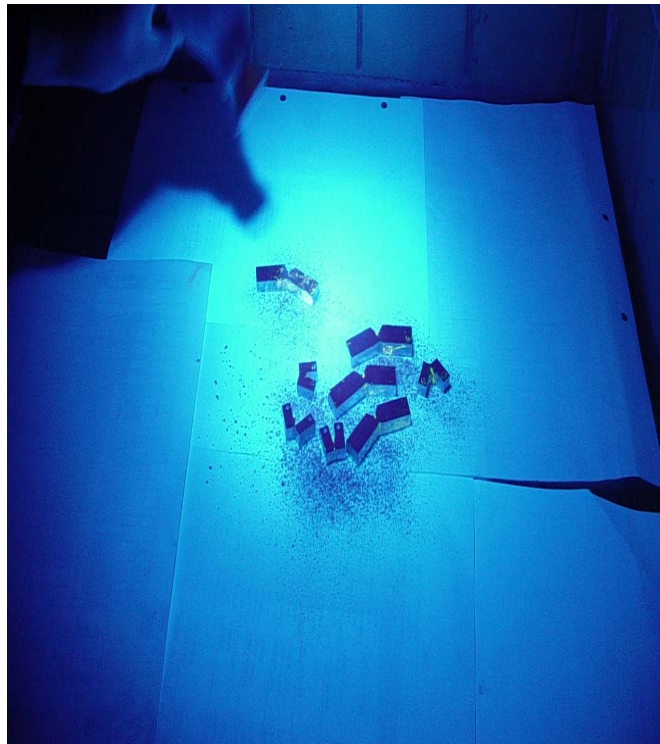
Figura 4-12 : Probetas aplicadas líquidos penetrantes en luz ultravioleta (laboratorio de NDI Ala No. 12).
