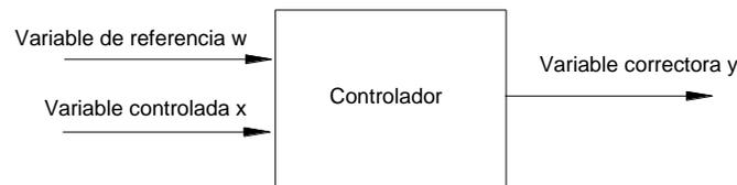
Fig. 4.42 Diagrama de bloque de un controlador
