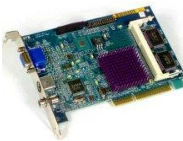
Figura 2.3 Fotografía ilustrativa de tarjeta capturadora de video
