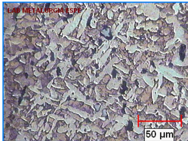
Figura 5.76 Imagen digitalizada Latón, 200 X
