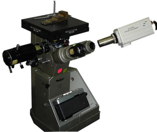
Figura 3.8 Diagrama ilustrativo de montaje de la cámara al lente del microscopio
