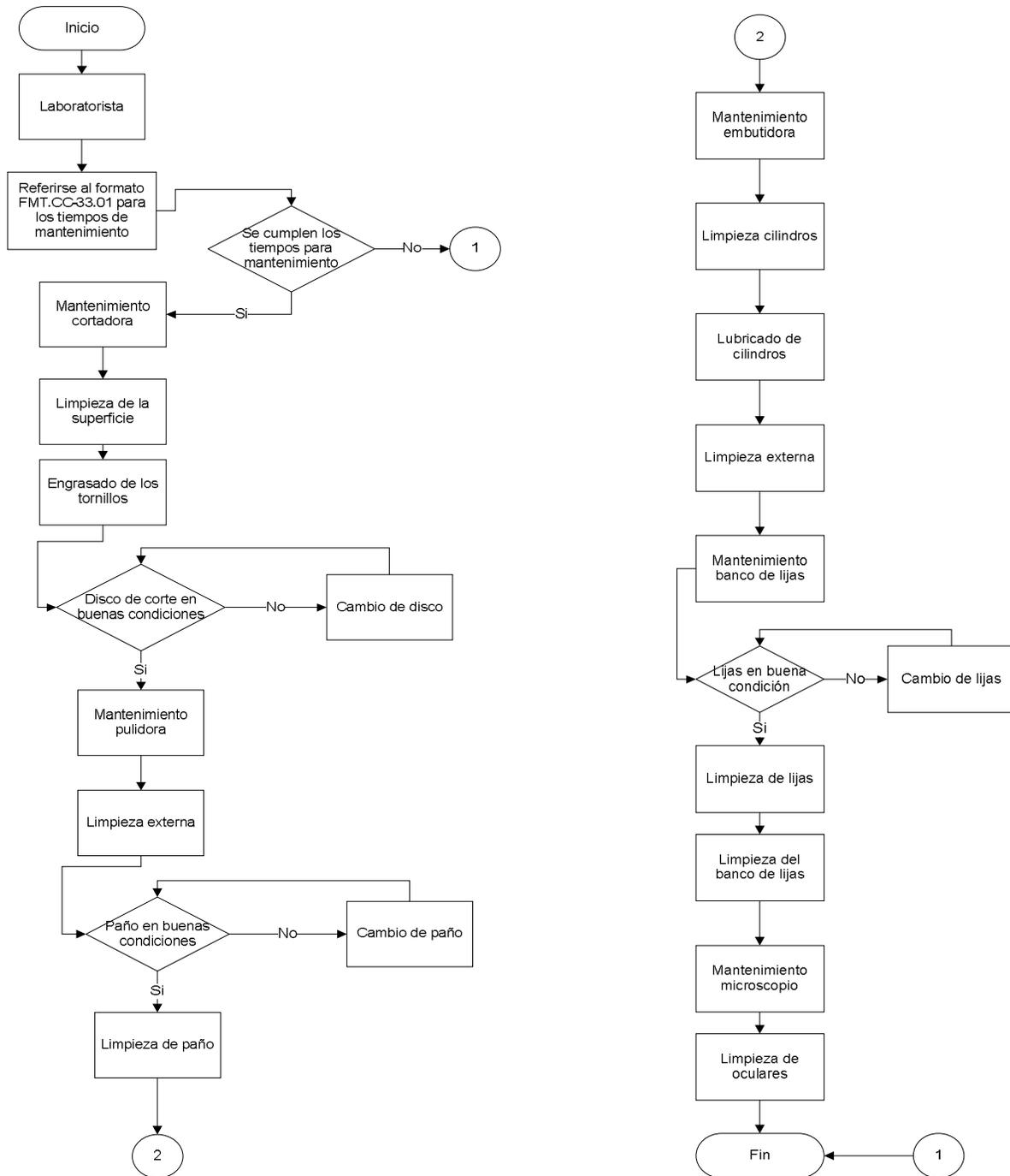
Figura 3.12 Flujograma del proceso de mantenimiento de los equipos de micrografía<sup>20</sup>
