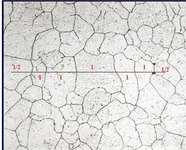
FIGURA2.8: Ilustración del método de intersección para tamaño de grano<sup>8</sup>.
