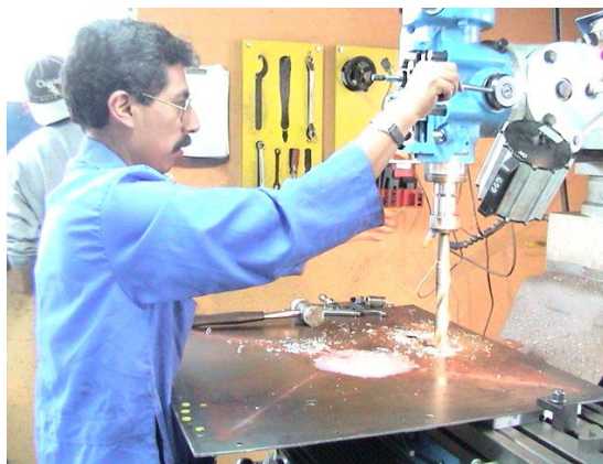
Figura 5. 1 Trabajos de taladrado y mandrinado en planchas
