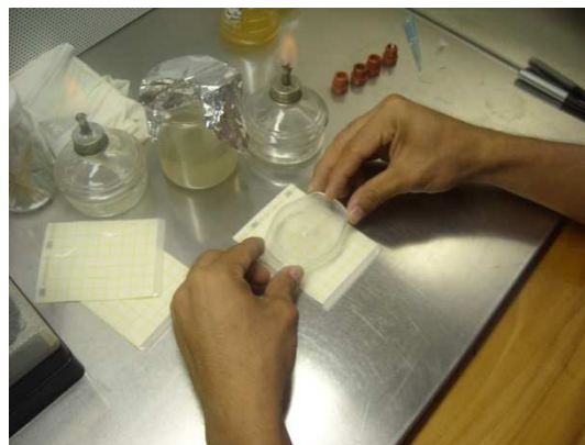
c. Colocación del difusor 3M
