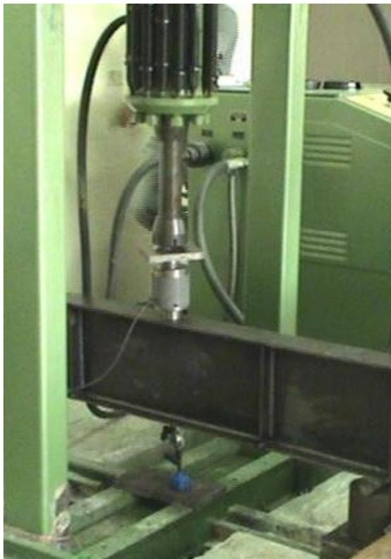
La figura 5.19 muestra el primer comparador de reloj justo debajo del punto de aplicación de la carga.
