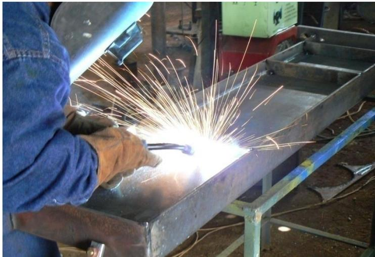
La figura 5.9 muestra el procedimiento GMAW de soldadura alma patín de la columna.
