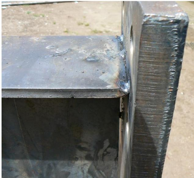
La figura 5.5 muestra el procedimiento de soldadura GMAW alma-patín en la viga.
