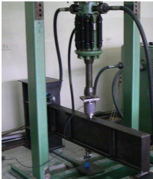
La figura 5.17 muestra el ensayo del prototipo, en éste caso se uso una celda de carga para comprobar la carga que mostraba el equipo.
