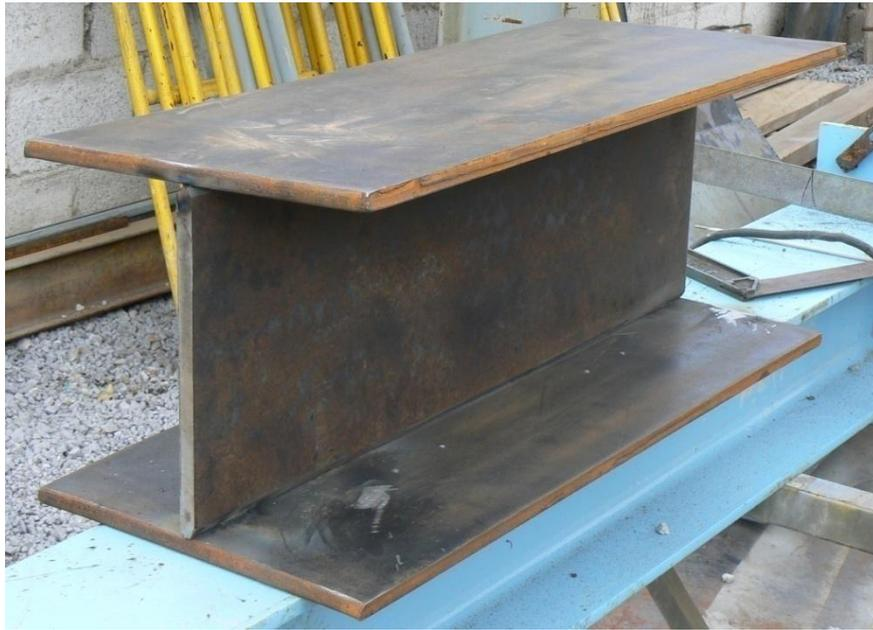
La figura 5.2 muestra la placa extendida trazada y perforada antes de soldarla al final de la viga, también se observa algunos rigidizadores de la viga.
