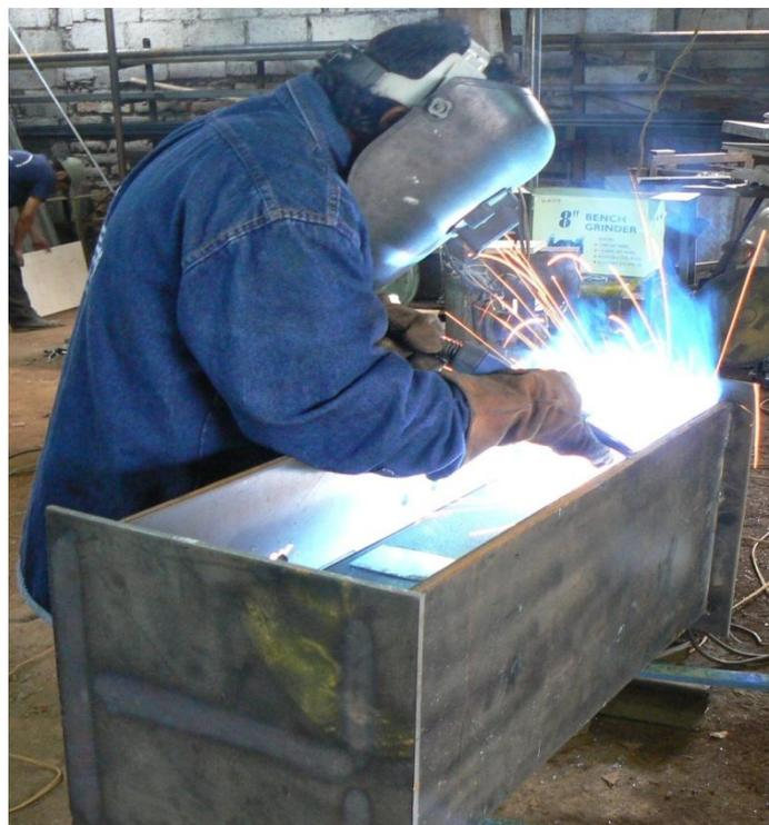
La figura 5.11 muestra el procedimiento de soldadura GMAW del rigidizador de la columna a la altura de los patines de la viga.
