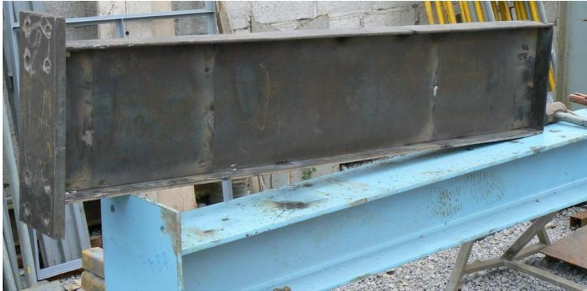
La figura 5.4 muestra el bisel del patín de la viga para la junta viga placa extendida de acuerdo al WPS No CON-2008-01.
