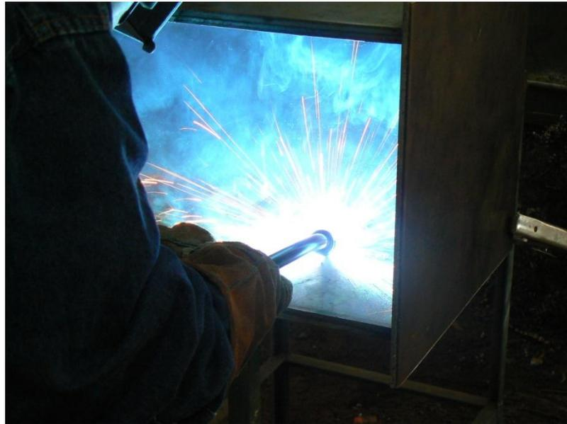
La figura 5.10 muestra el proceso de soldadura GMAW entre la placa de apoyo y la columna.
