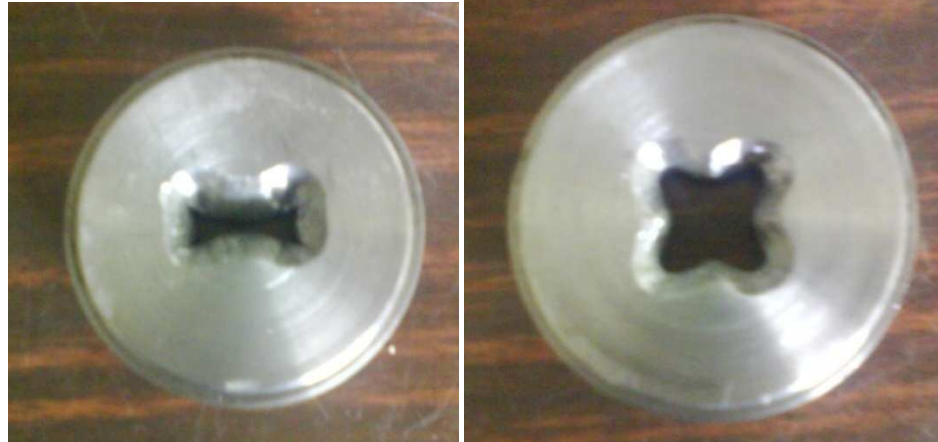
Figura 5.17 Boquillas después del desbaste con la fresadora
