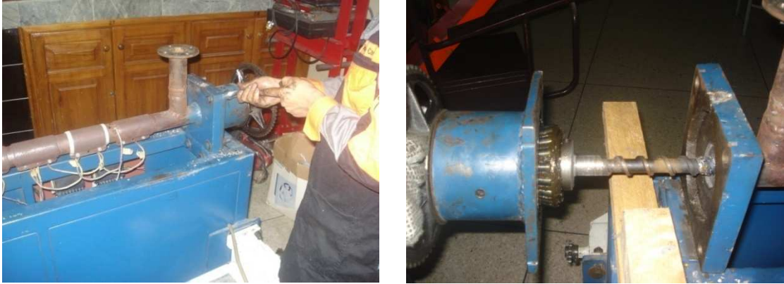
Figura 6.2 Desmontaje partes de la extrusora
