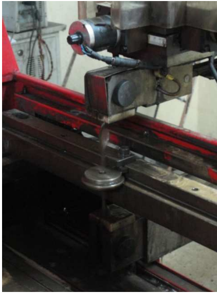
Figura 5.13 Colocación del hilo
