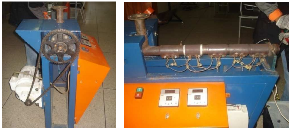
Figura 6.1 Desmontaje carcasa de la extrusora
