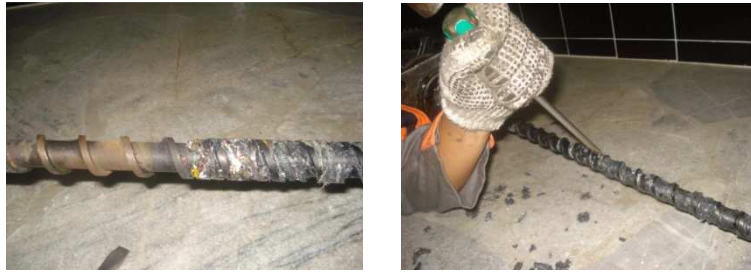
Figura 6.4 Limpieza del tornillo
