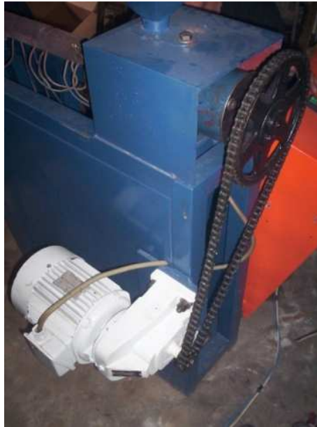
Figura 3.2 Sistema piñón, rueda y cadena
