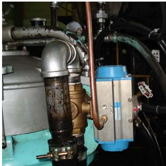
**Figura 5. 5. Montaje final de la válvula para control de aceite de 3/2**
