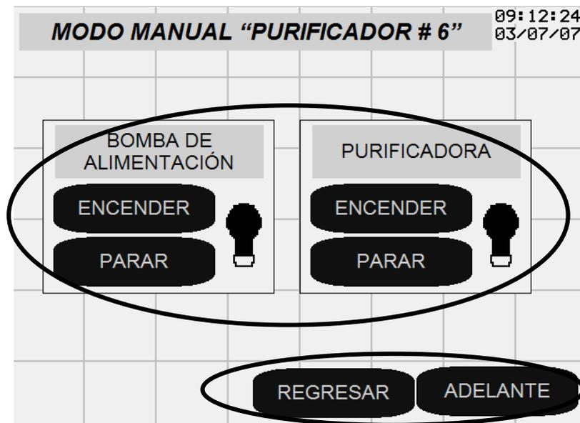
Para empezar la operación manual, verifique que el indicador de velocidad muestre 1800 rpm, a continuación verifique que la válvula V4 este abierta y V5 cerrada. Si el aceite esta muy frío mantenga cerrado V4 y abierto V5 por un tiempo prudente hasta que el aceite se haya calentado, pero se debe mantener el módulo purificador apagado. Si ya se ha calentado lo suficiente encienda el módulo purificador desde los botones o desde la pantalla.
