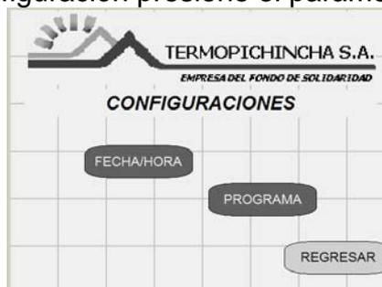
3. Si desea cambiar la configuración de la fecha y hora presione en los botones para subir o bajar el valor de los parámetros. Para salir pulse REGRESAR.
