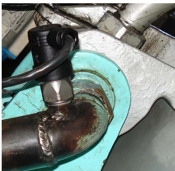
Figura 5.11. Montaje final del sensor de presión
