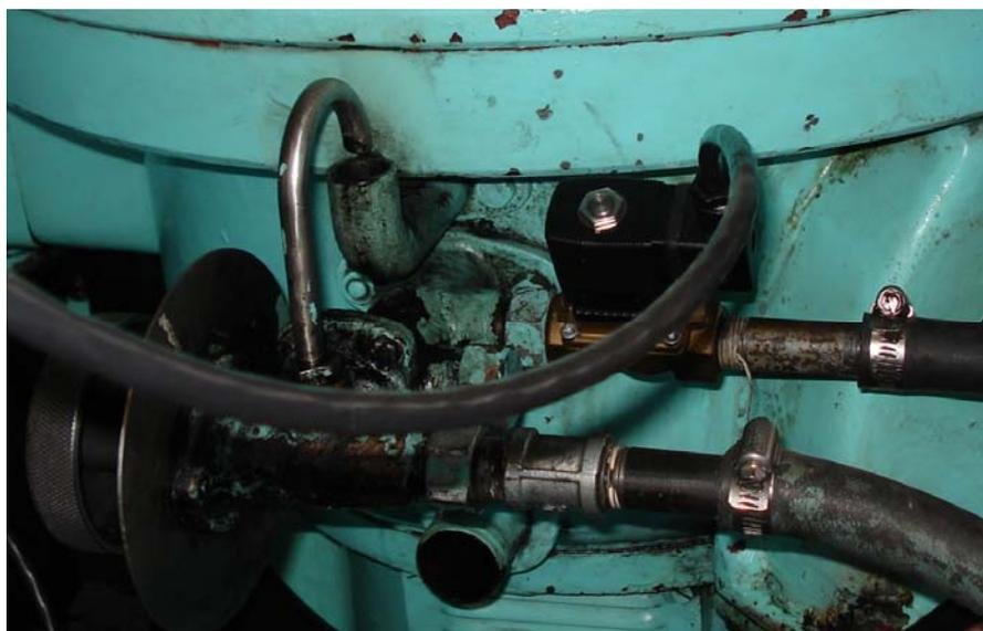
Figura 5.7. Montaje final de la válvula de agua de control
