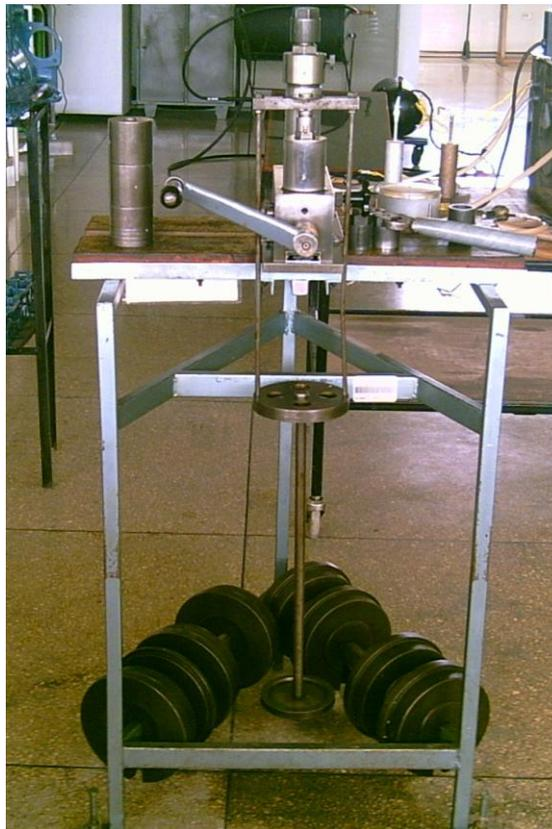
**Fig. 3.17. Calibrador de manómetro ASMLER**
