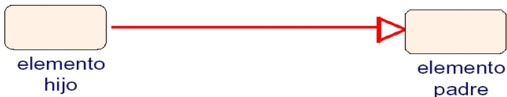
**Figura 2.14 : Modelado UML: generalización.**
