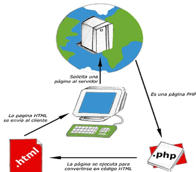
**Figura 2.15 : Esquema del funcionamiento de las páginas PHP.**
