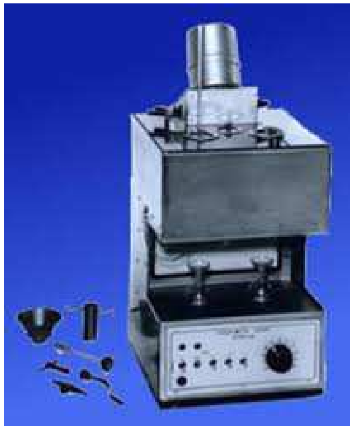
Figura 3.6 Viscosímetro de Oswald- Cannon-Fenske
