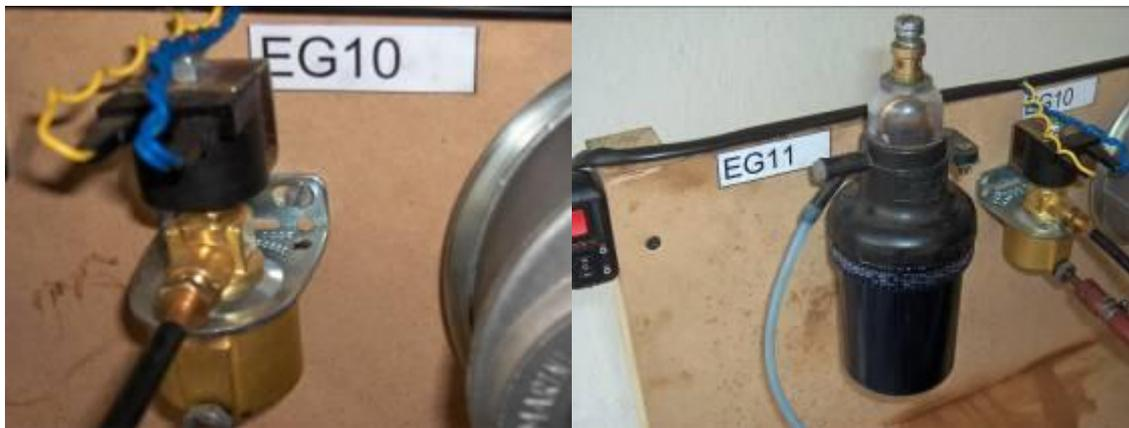
**Figura 4.20** EG10 Electro válvula y EG11 Dosificador de aceite.
