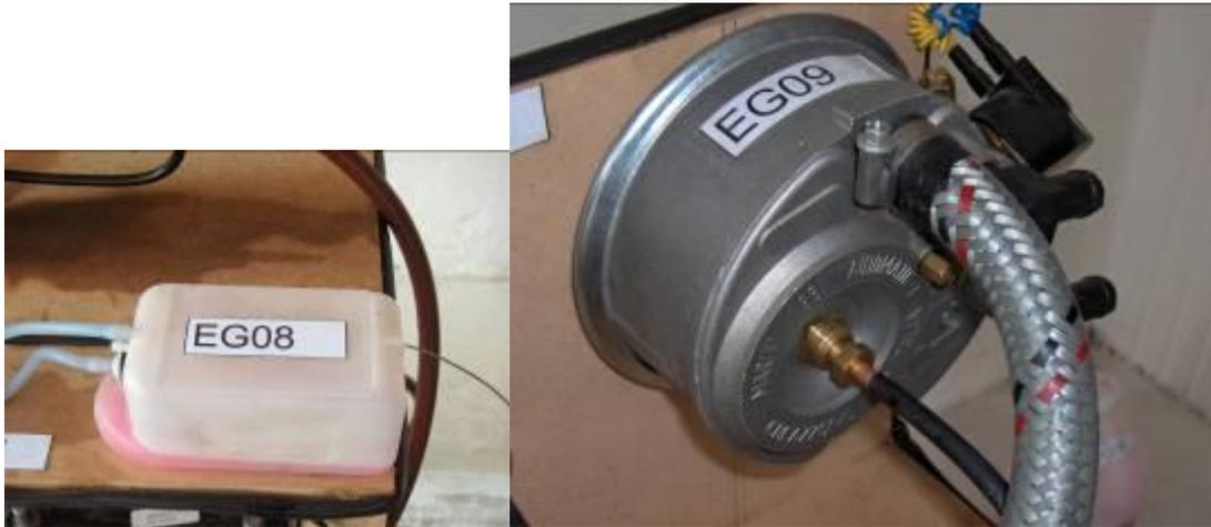
**Figura 4.19** EG08 Tanque almacenamiento combustible y EG09 Difusor de gas.
