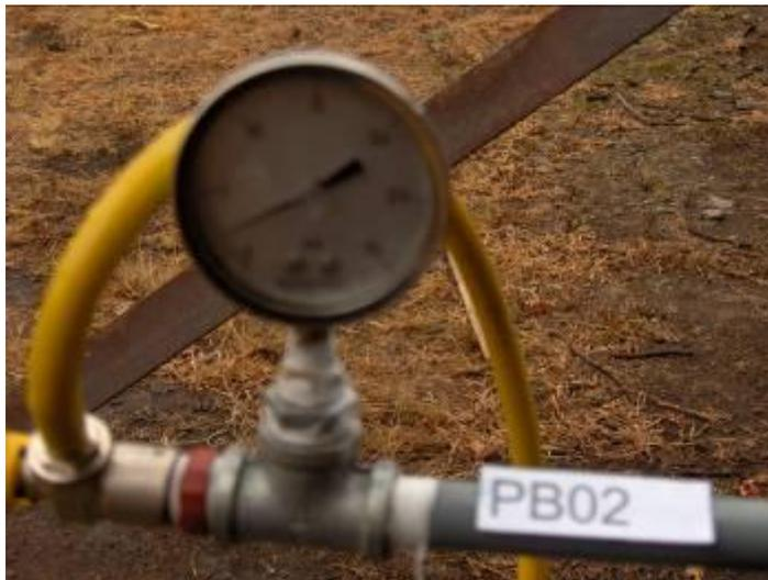
**Figura 4.15 PB02 Manómetro (marca 1,7 psi).**
