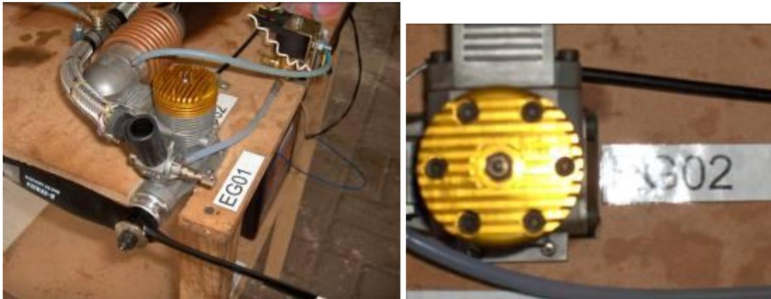
**Figura 4.16 EG01 Motor GMS 61/2000 dos tiempos y EG02] bujía.**
