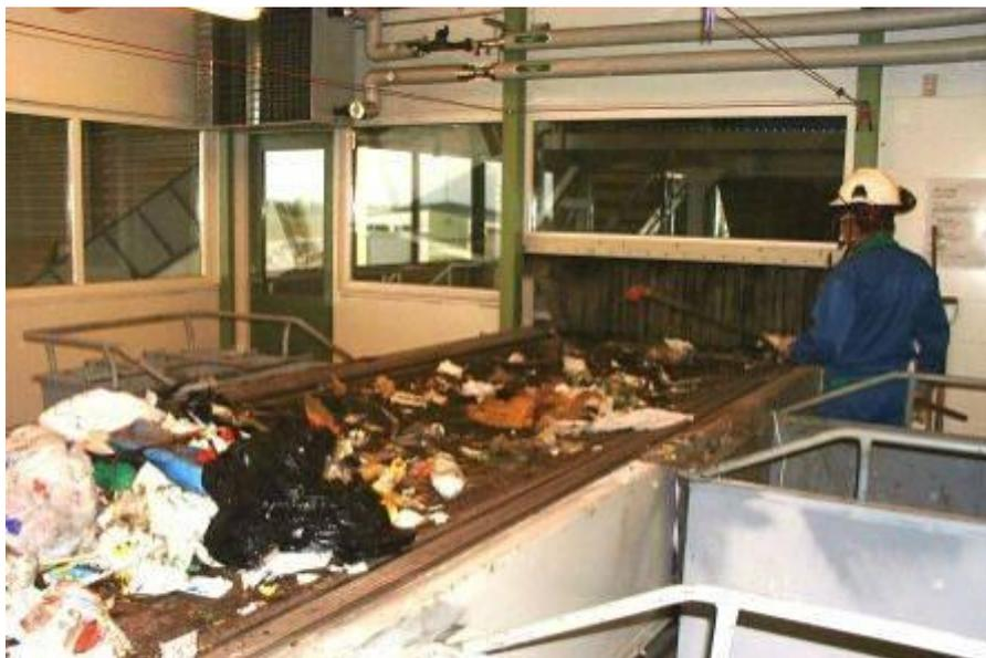
**Figura 3.2.** Selección, separación mediante bandas.
