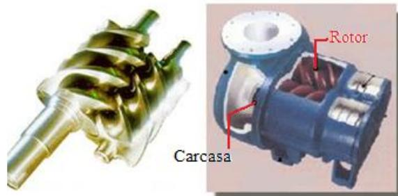
**Figura. 1.3. Compresor rotativo de tornillo**
