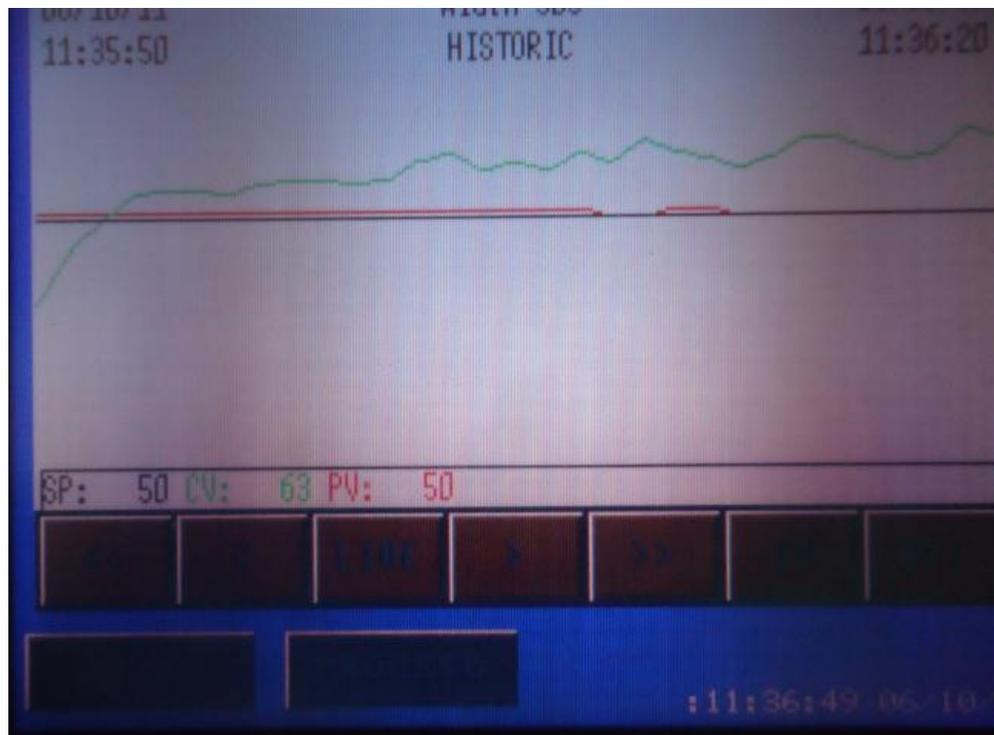
**Figura. 3.27. Respuesta del sistema con un control PI**
