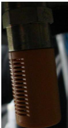
**Figura 3.17. Filtro Silenciador de Aire**
