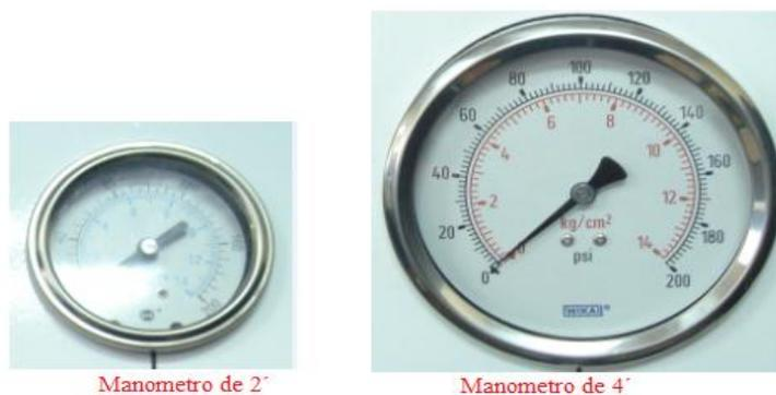
**Figura. 3.14. Manómetros Posteriores con rango de 0-200 PSI**
