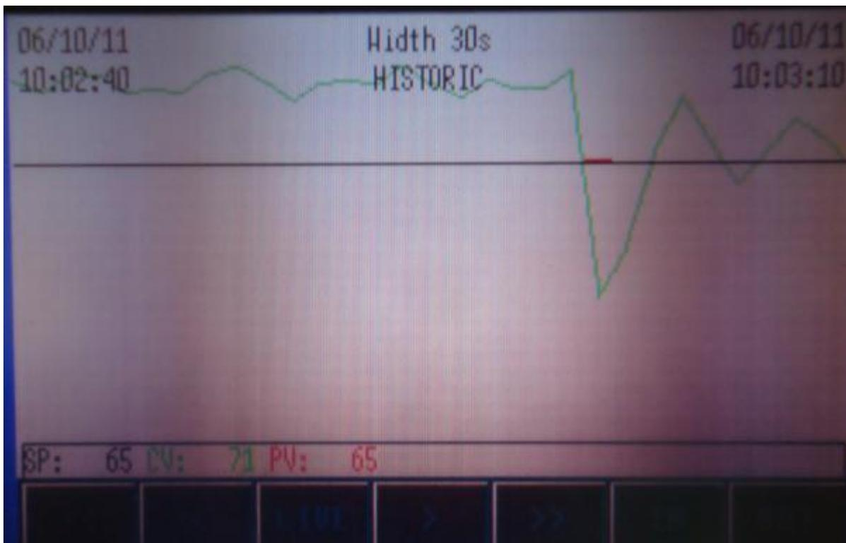
Figura 3.31. Respuesta del sistema con un control PID aplicando una perturbación
