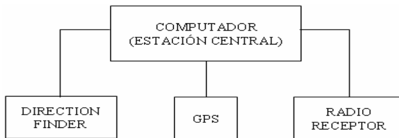
Figura Nº 3.3 Diagrama en bloques de los equipos Comint.
