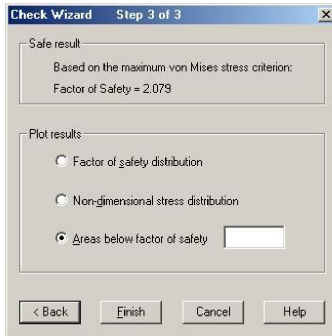
Figura 3.17 Factor de seguridad para el elevador ( F.S. = 2.079 )
