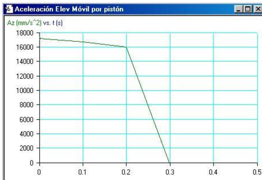
Figura 3.29 Aceleración generada sobre el elevador móvil en su desplazamiento vertical para elevación de carga, el movimiento es provocado por la fuerza aplicada desde el pistón montado en el elevador fijo
