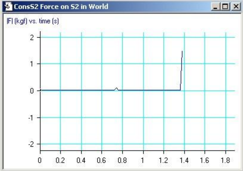
Figuras 3.46, 3.47 Fuerza generada por las vigas corredizas sobre los ejes soporte laterales anclados en la mesa base, estos elementos previenen posibles desplazamientos laterales de las vigas.
