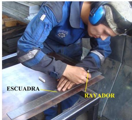
Figura 4.9: Trazado de la ubicación de los elementos
