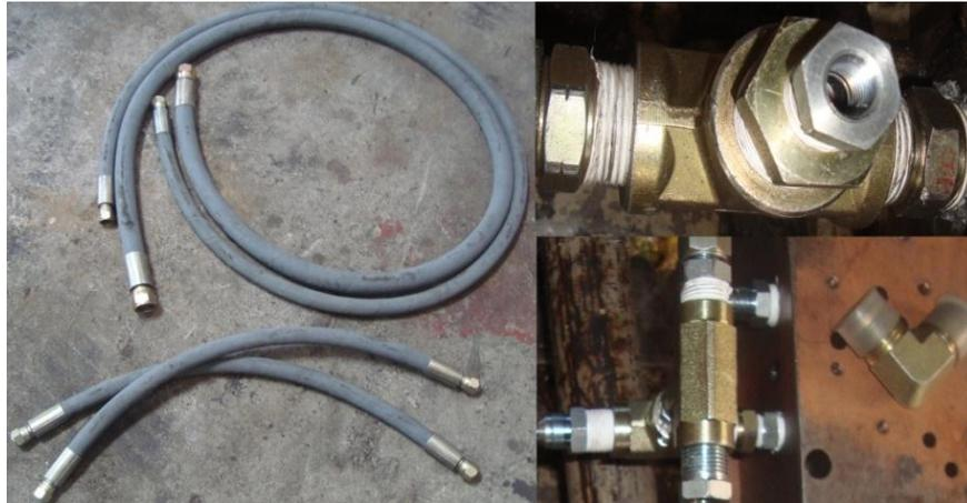
Figura 3.5: Mangueras y acoples hidráulicos
