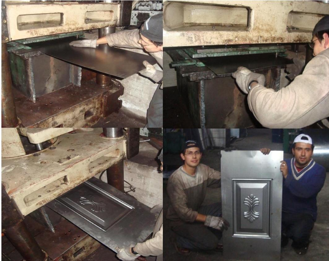
Figura 5.22: Estampado en lámina de tol en la prensa hidráulica
