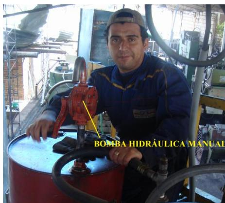
Figura 4.30: Llenado del tanque de aceite utilizando bomba manual
