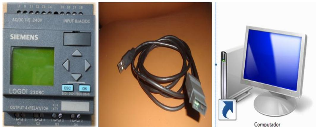
Figura 2: Interfaz entre el PLC SIEMENS LOGO 230 RC y la PC
