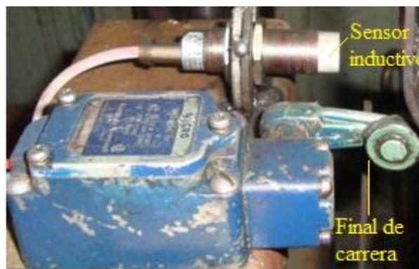
Figura 3.23: Final de carrera y sensor inductivo
