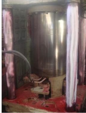
Figura 5.5: Aplicación del líquido revelador en las columnas
