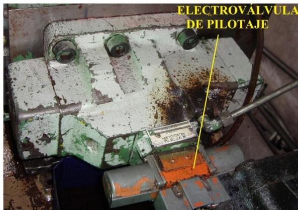
Figura 4.24: Electroválvula montada en la válvula direccional principal
