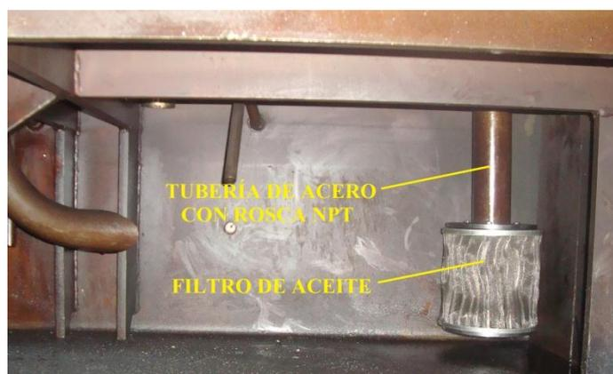
Figura 4.28: Filtro de aceite montado en la línea de succión
