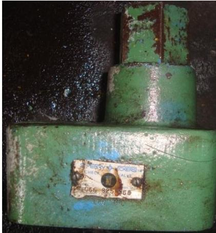
Figura 3.11: Válvula antirretorno o check
