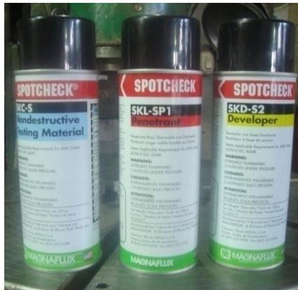
Figura 5.2: Líquidos especiales para la prueba de fisuras
