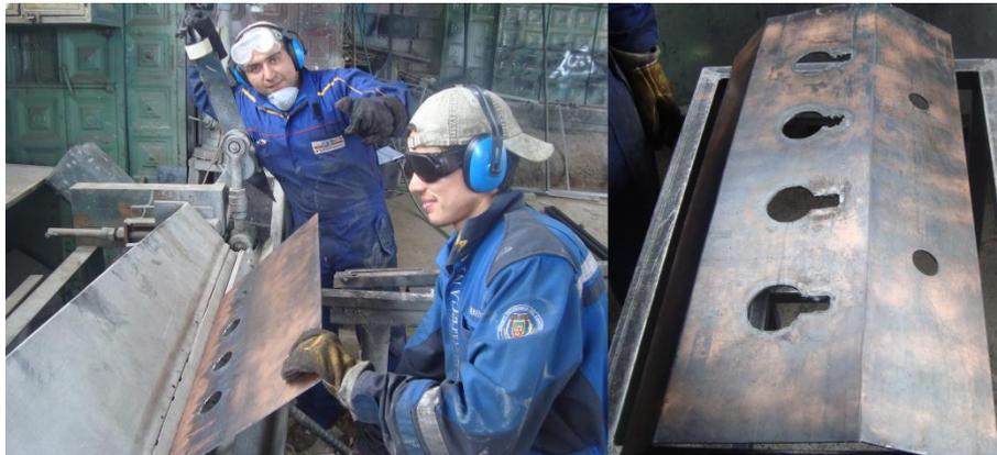
Figura 4.11: Doblado del tablero de manómetros y presóstatos
