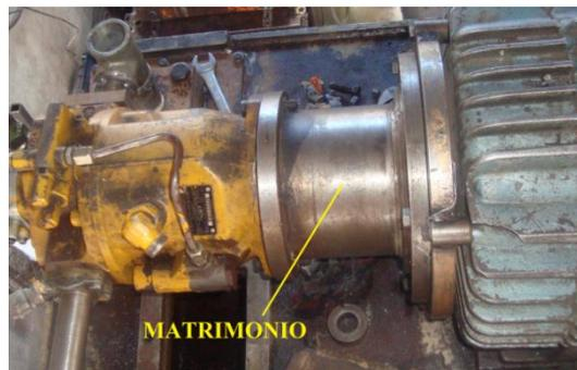
Figura 4.13: Acople del motor eléctrico con la bomba hidráulica
