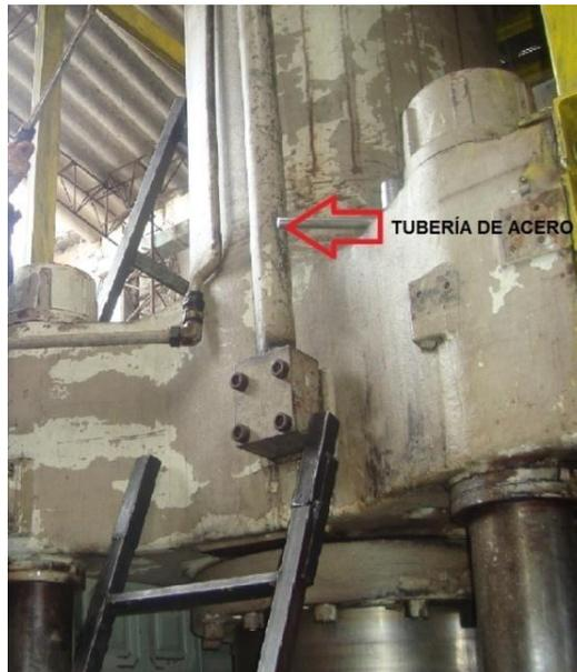
Figura 3.4: Tubería de acero en la prensa hidráulica
