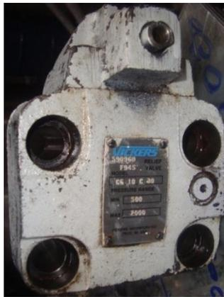
Figura 3.9: Válvula reguladora de presión
