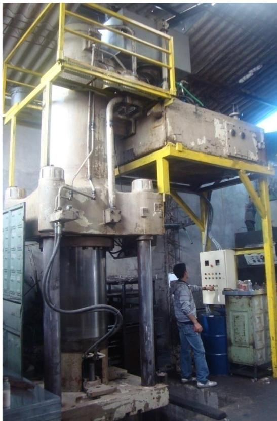
Figura 4.49: Prensa Hidráulica Hidrogarne de 300 Toneladas
