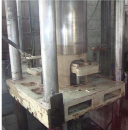
Figura 5.1: Columnas guías que soportan la prensa hidráulica
