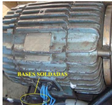
Figura 4.12: Motor montado en las bases soldadas
