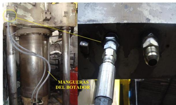
Figura 4.21: Mangueras instaladas y conectores tipo JIC macho
