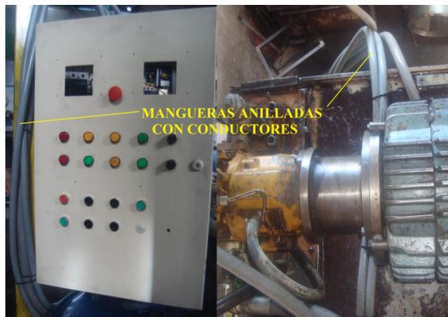
Figura 4.36: Cableado del circuito de fuerza y actuadores
