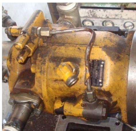
Figura 3.2: Bomba hidráulica Hydrotec A10VO
