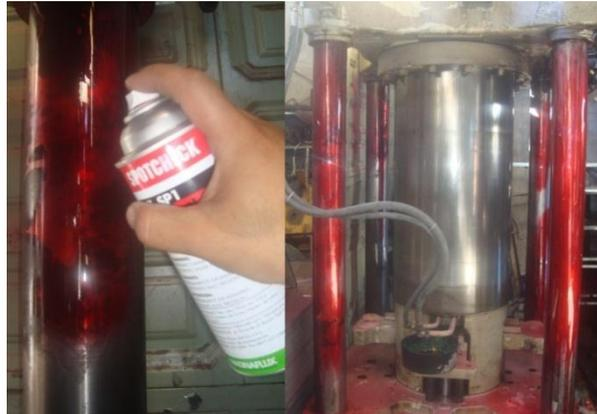
Figura 5.4: Aplicación del líquido penetrante en las columnas
