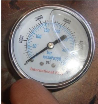
Figura 3.13: Manómetro hidráulico
