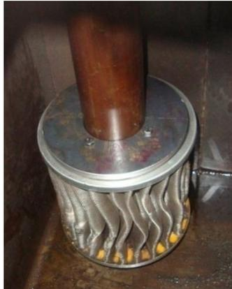
Figura 3.12: Filtro de aceite hidráulico
