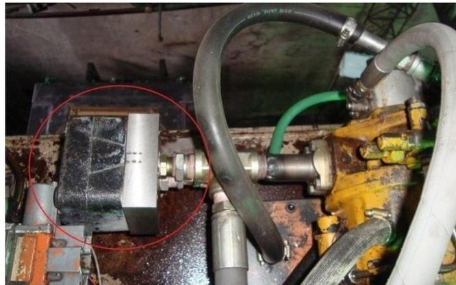
Figura 5.10: Válvula reguladora de presión del sistema hidráulico
