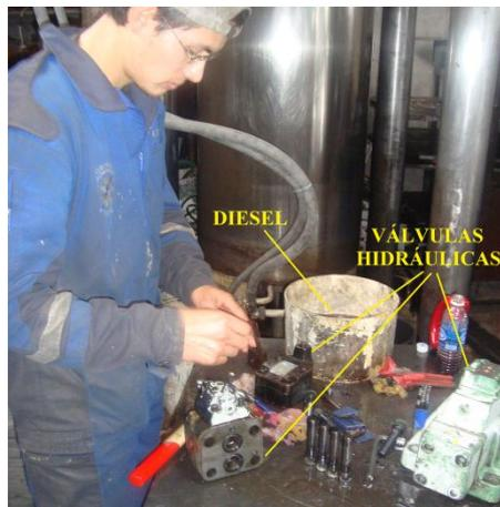
Figura 4.17: Mantenimiento y limpieza de las válvulas hidráulicas
