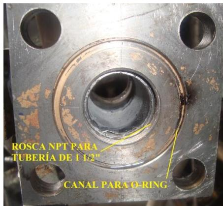
Figura 4.25: Rosca NPT y mecanizado en la brida
