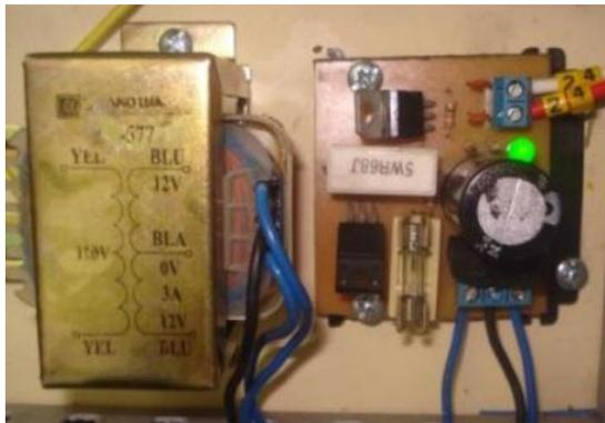
Figura 3.22: Fuente de corriente continua armada
