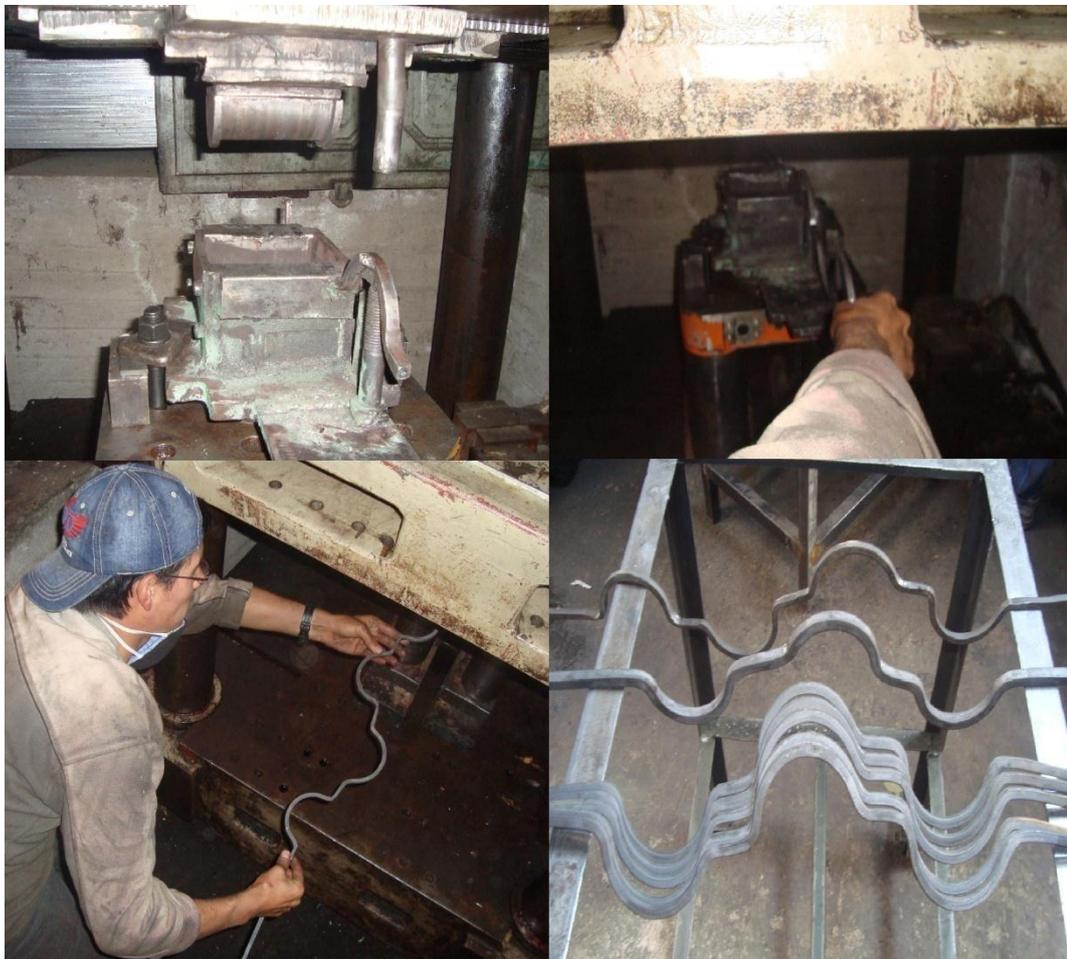
Figura 5.17: Doblado de varillas en la prensa hidráulica
