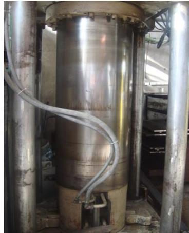
Figura 2.16: Columnas de la prensa hidráulica
