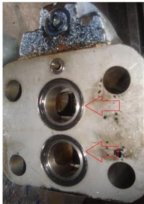
Figura 5.8: O-rings colocados en las válvulas del bloque manifold
