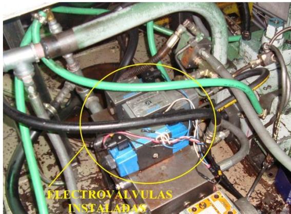
Figura 4.23: Electroválvulas montadas en el bloque manifold secundario
