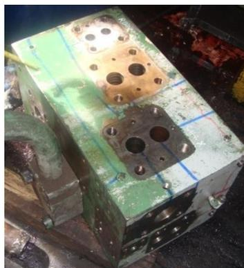
Figura 2.25: Bloque principal para el montaje válvulas hidráulicas
