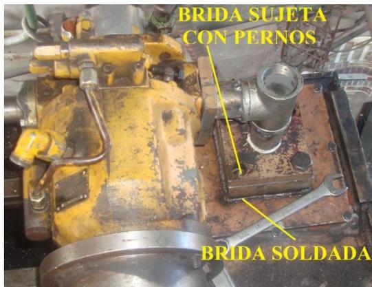
Figura 4.27: Montaje de las bridas a la entrada de la bomba
