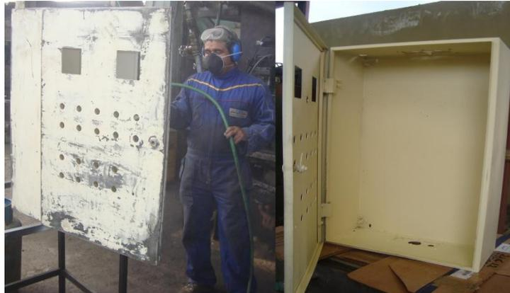
Figura 4.33: Reconstrucción del tablero de control
