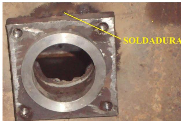
Figura 4.6: Bocín de la brida soldado a la base del tanque
