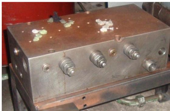
Figura 2.27: Bloque secundario para el montaje de electroválvulas
