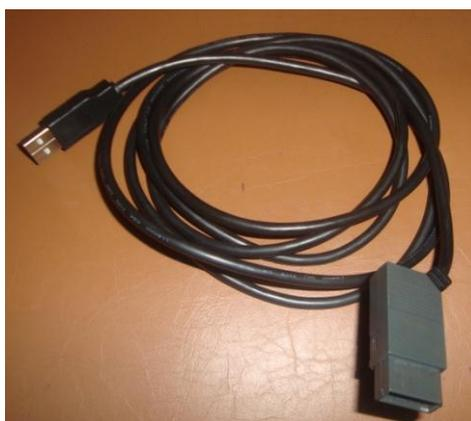
Figura 4.45: Cable de conexión LOGO! – PC puerto USB
