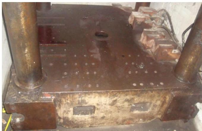
Figura 2.2: Mesa fija o bastidor de la prensa
