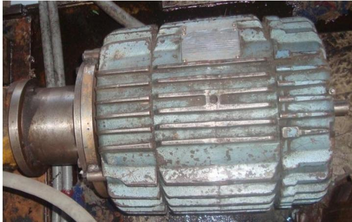
Figura 3.14: Motor eléctrico para accionar la bomba hidráulica
