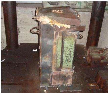
Figura 5.9: Probeta para las pruebas de presión
