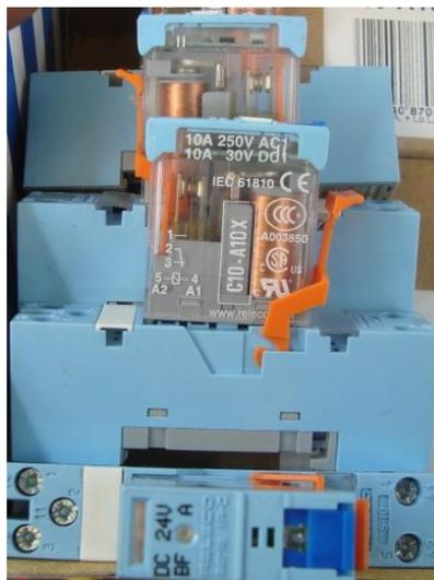
Figura 3.21: Relés auxiliares con base incluida
