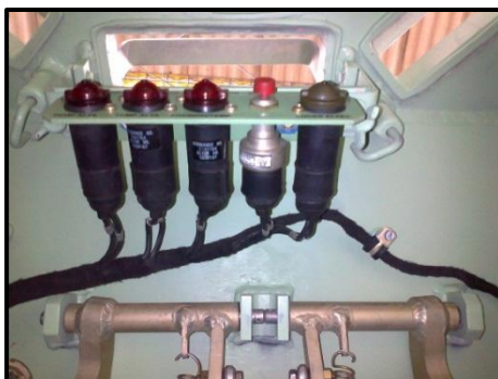
Figura. 4.41 Panel de luces de advertencia
