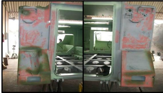
Figura. 3.108 Marcación para corte de guardafangos izquierdo y derecho
