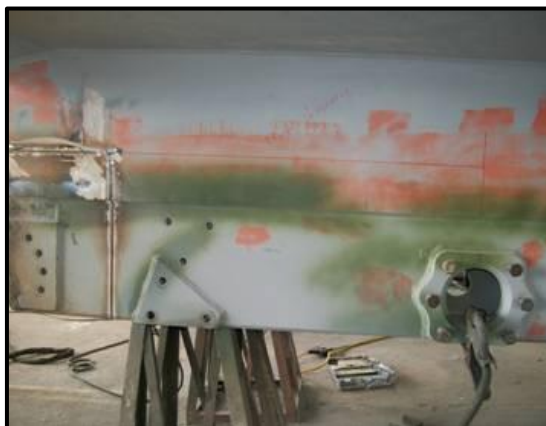
Figura. 3.73 Marcación de partes a ser removidas
