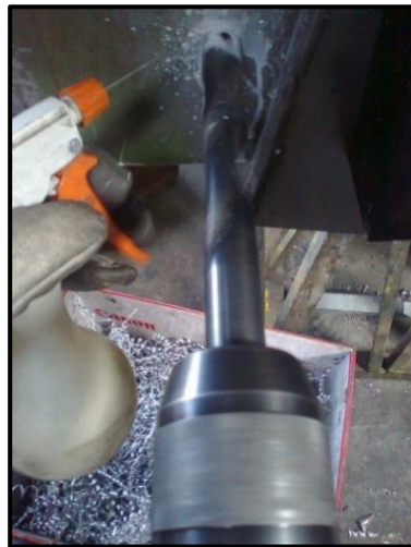
Figura. 3.90 Perforación con broca 26.50mm, profundidad de 45mm
