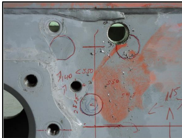
Figura. 3.23 Identificación de insertos a ser removidos
