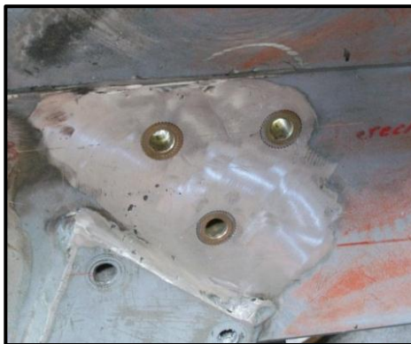
Figura. 3.61 Colocación de corona
