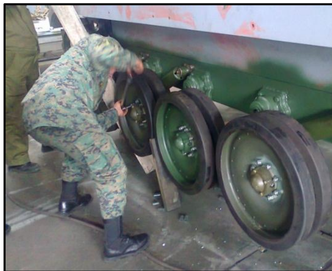
Figura. 4.57 Aplicar torque a las tuercas de las ruedas de camino 170-190ft/lbs.
