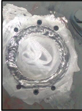
Figura. 3.105 Cordón de acabado
