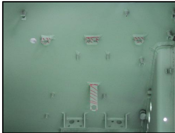
Figura. 3.64 Piezas a cortar
