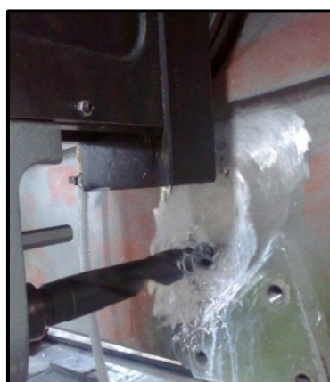
Figura. 3.53 Perforado broca 28.50mm
