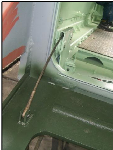
Figura. 4.51 Cable de la rampa
