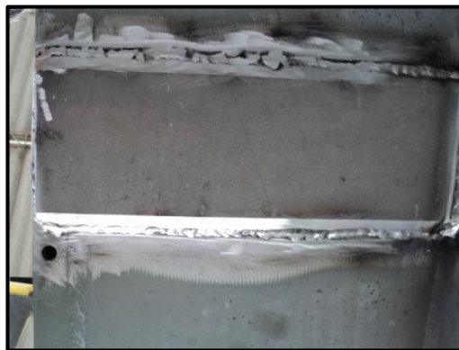
Figura. 3.101 Desbaste y pulido de la pieza soldada
