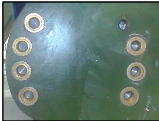
Figura. 3.94 Colocación de coronas
