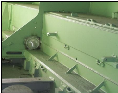
Figura. 3.15 Suelda del orificio de toma de aire de la tripulación
