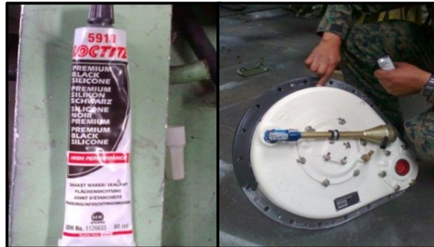
Figura. 4.13 Aplicación de pegamento
