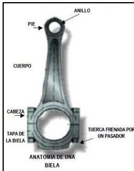
Figura. 2.10 Biela y cuerpo de biela
