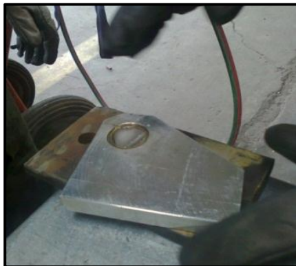
Figura. 3.7 Enfriamiento del bocín
