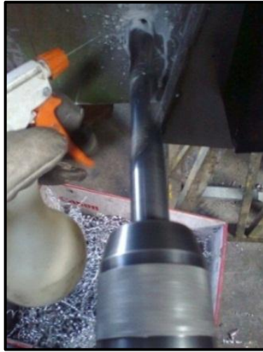
Figura. 3.87 Perforación con broca 20mm
