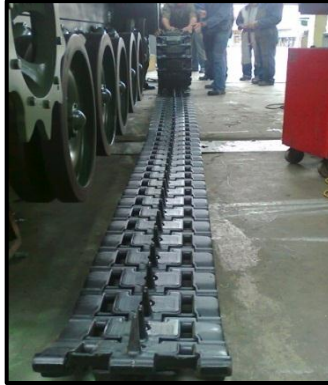
Figura. 4.58 Emplazamiento de oruga
