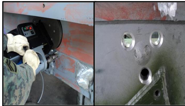
Figura. 3.25 Biselado de orificios
