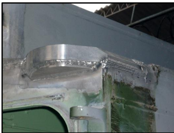
Figura. 3.83 Suelda parte inferior
