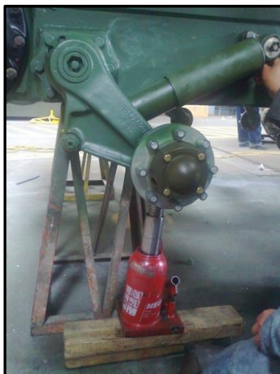
Figura. 4.28 Colocación del Amortiguador
