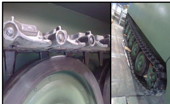
Figura. 4.63 La altura entre la rueda de camino y la oruga es de 50mm.
