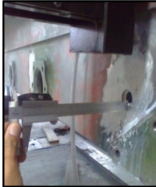
Figura. 3.54 Profundidad de 5,40mm- 5,70 mm
