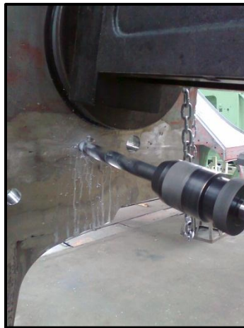
Figura. 3.123 Perforaciones de alimentación y retorno de combustible
