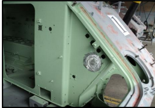
Figura. 3.14 Suelda del orificio de toma de aire
