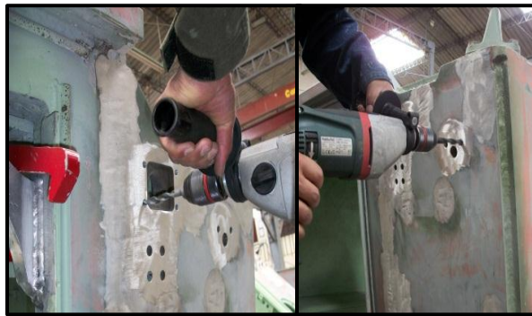
Figura. 3.112 Limpiar los orificios
