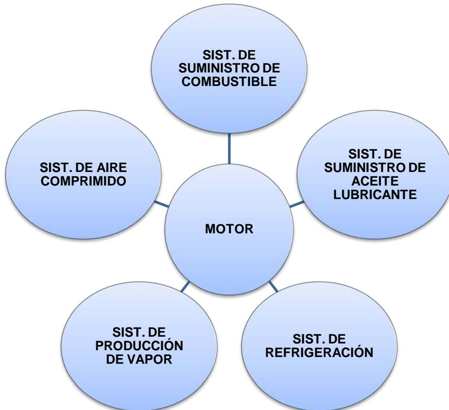
Figura. 4.2.1.1. Diagrama de los Sistemas Auxiliares.<sup>24</sup>
