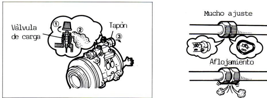
Figura 4.30 Reemplazo de Tuberías
