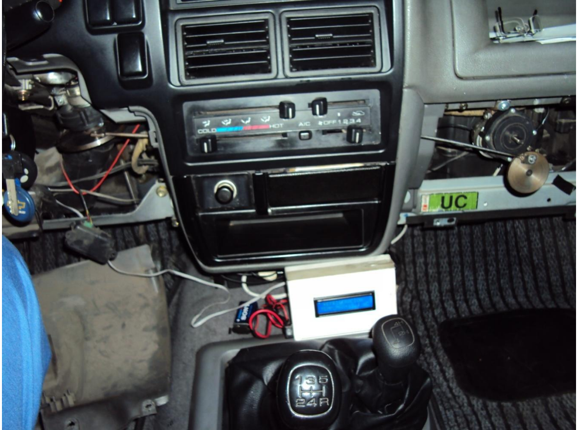
Montaje de los Motores de Mando
