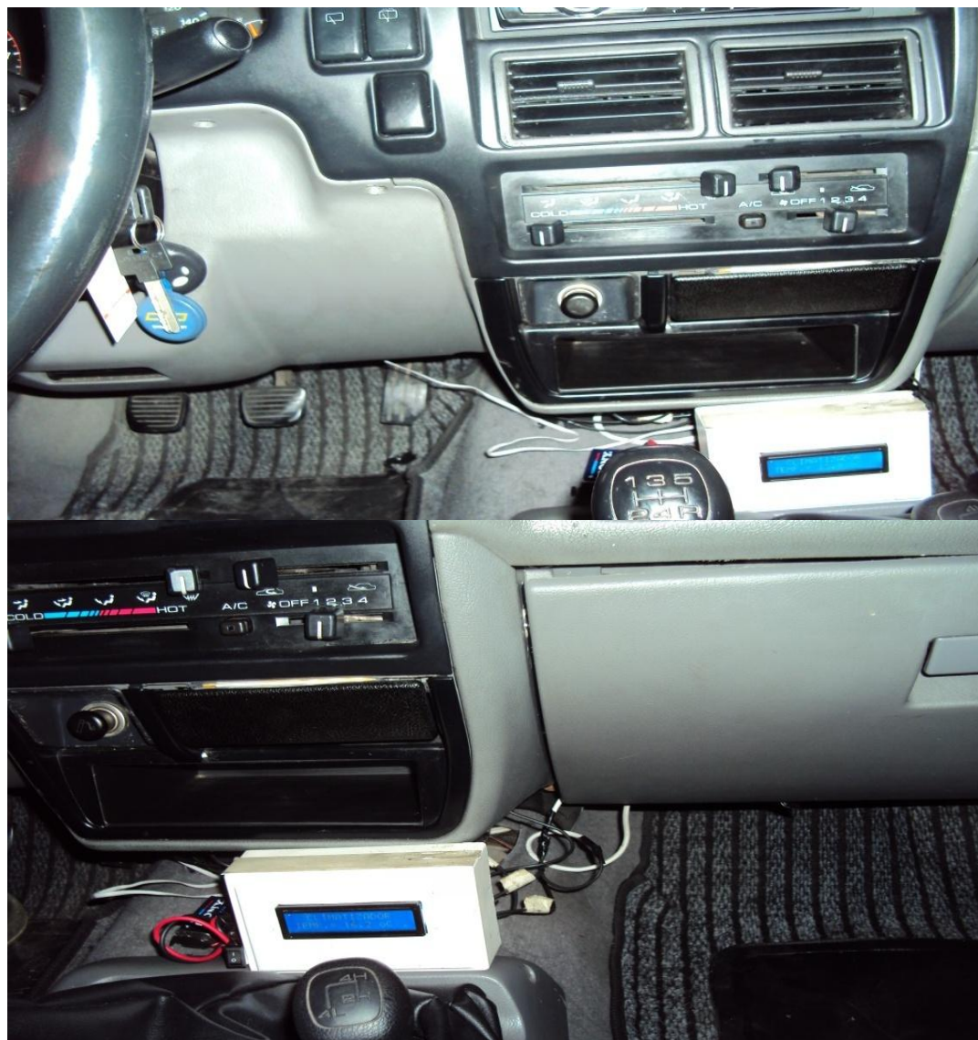
Montaje Completo del Modulo de Climatización
