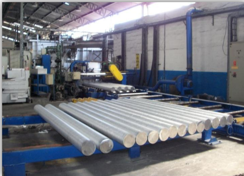
Figura 2-2 Producción de lingotes de Aluminio Planta de Fundición Fuente CEDAL
