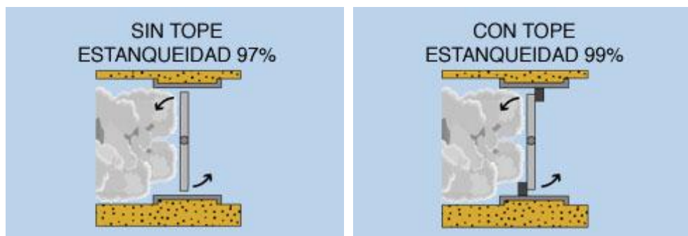
Figura 2-4 Tipos de cierre para D mper
