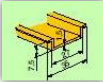
Figura 3-24 Riel DIM utilizado para la instalación.
