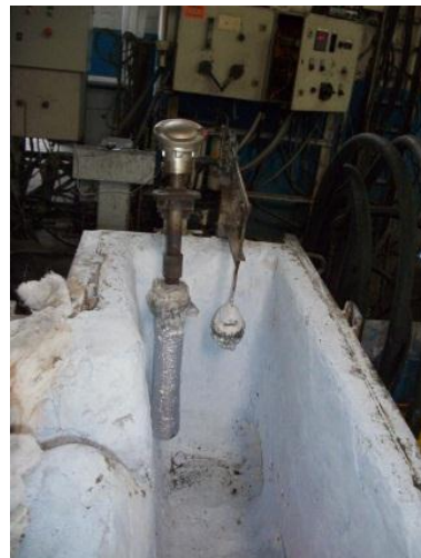
Termocupla de la colada (Tundish)
