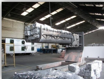
Figura 1-8 Área de Fundición. La chatarra ingresa al horno de fundición para la formación de los lingotes. Fuente CEDAL
