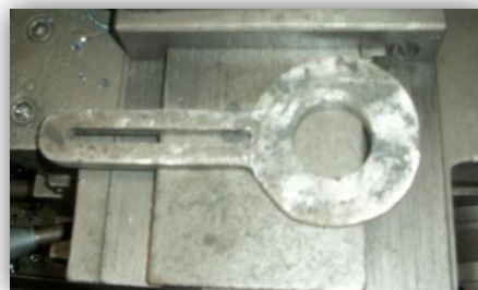
Figura 3-5 Acople Dámper al Modutrol
