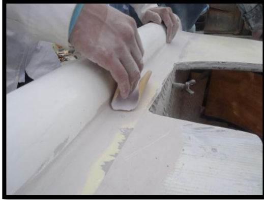
Figura 4. 56 –Lijado de bordes laterales.
