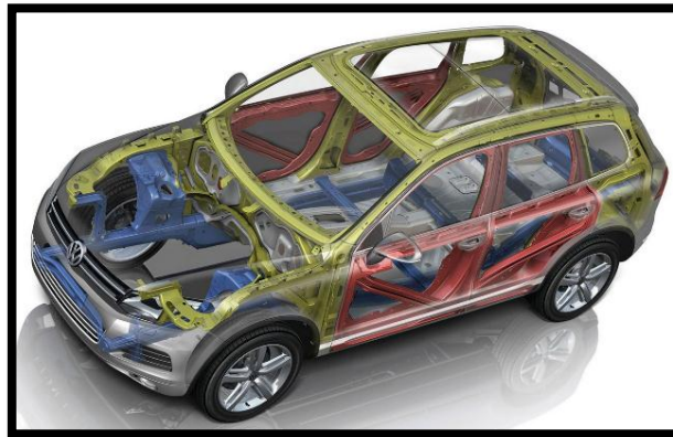
Figura 4. 4 – Carrocería auto portante.
