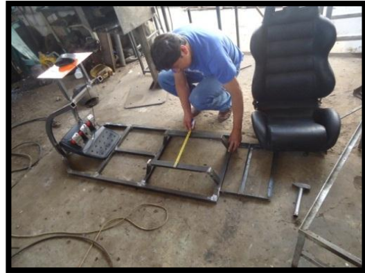
Figura 4. 33 – Medidas para base del asiento.
