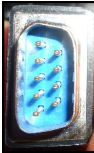
Figura 5. 10 – Pines conectores de los pedales macho.
