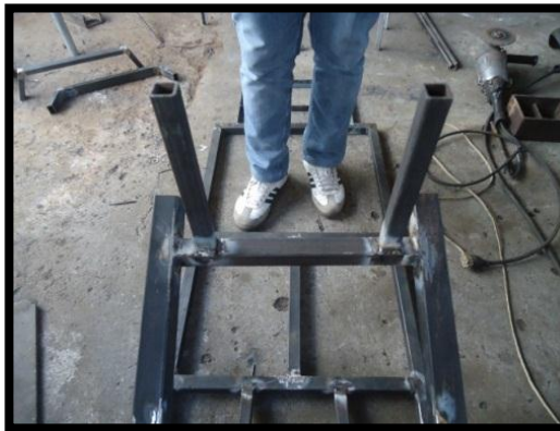
Figura 4. 30 – Base del monitor.
