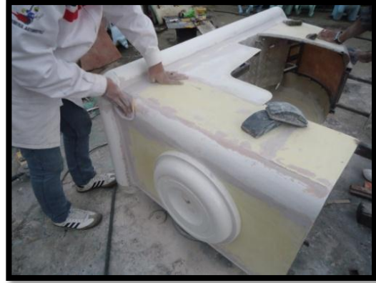
Figura 4. 57 –Lijado de bordes traseros.
