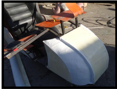
Figura 28 – Estructura con fibra de vidrio.
