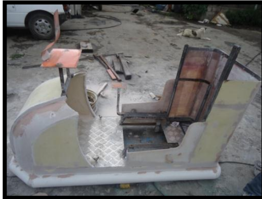
Figura 4. 58 –Lijado del conjunto.
