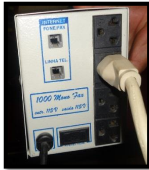
Figura 7. 15 – Regulador de voltaje.
