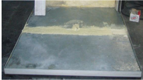
Figura 4.5 Base del banco simulador con panel de poliestireno
