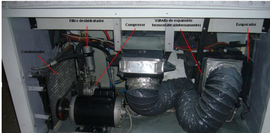
Figura 6.1 Componentes básicos del sistema de A/C del banco simulador
