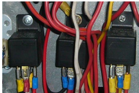
Figura 4.42 Relés de algunos componentes del banco simulador
