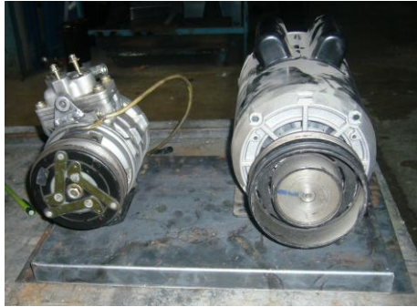
Figura 4.25 Base metálica para el compresor y motor eléctrico
