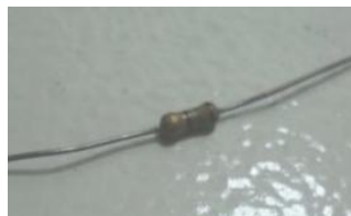
Figura 3.41 Resistencia de 590 ohmios
