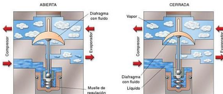
Figura 1.39 Válvula de expansión con regulación interna
