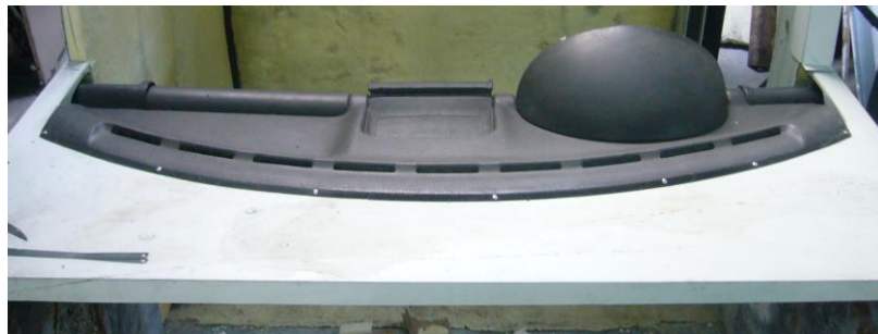
Figura 4.9 Tapa metálica en la cual esta remachado el tablero de un vehículo
