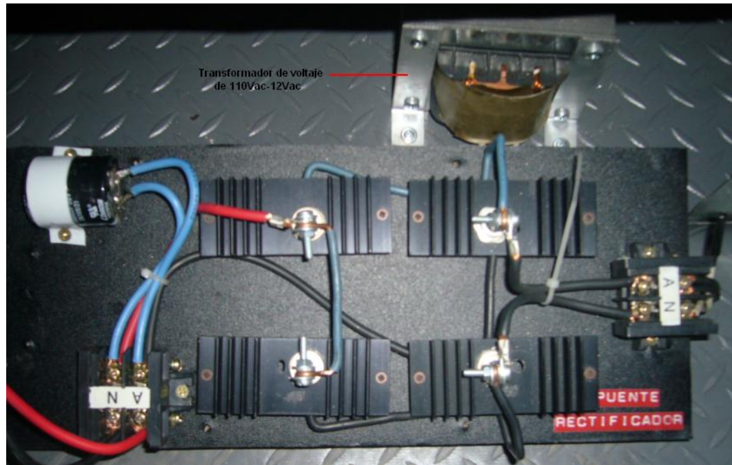
Figura 6.7 Transformador de voltaje y puente rectificador del banco simulador
