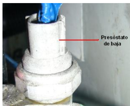
Figura 6.4 Presóstato de baja del banco simulador
