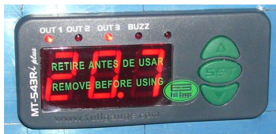
Figura 3.7 Controlador de temperatura MT-543 Ri plus
