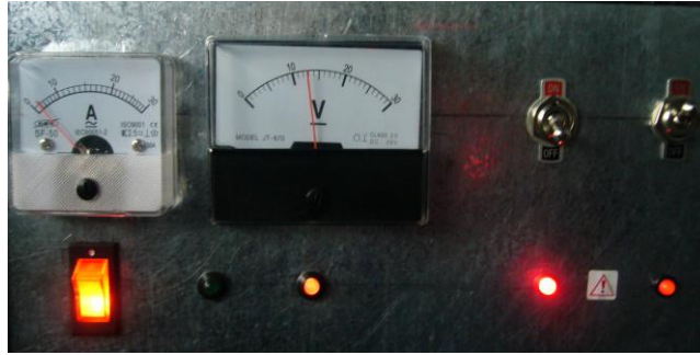
Figura 4.52 Falla de motor ventilador del evaporador activada
