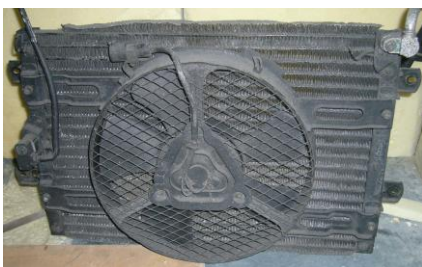
Figura 3.33 Ventilador del condensador de tipo serpentín
