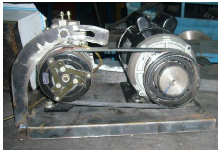
Figura 4.26 Colocación del templador en la base metálica
