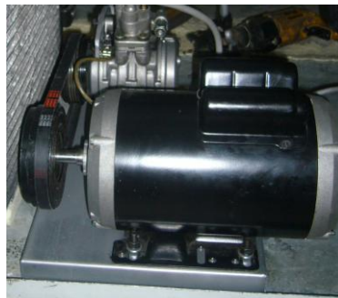
Figura 4.29 Fijación del conjunto motor eléctrico-compresor en el banco simulador
