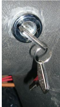
Figura 4.38 Switch de encendido del banco simulador
