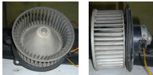
Figuras 3.35 Motor y ventilador del evaporador
