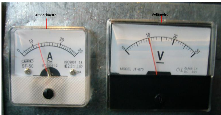
Figura 6.3 Amperímetro y voltímetro del banco simulador
