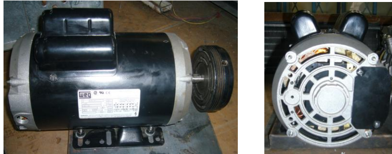
Figura 3.17 Motor eléctrico Weg de 2hp
