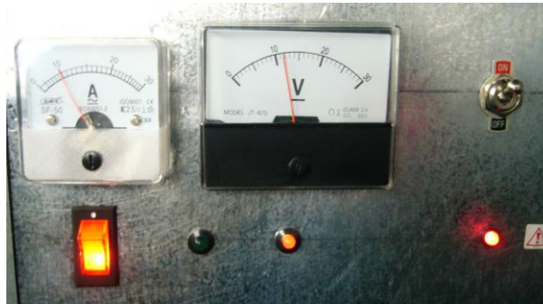
Figura 4.51 Falla de apagado del compresor activada
