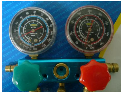
Figura 3.23 Juego de manómetros para refrigerante R-134a
