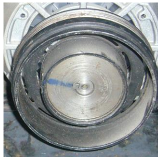
Figura 3.18 Polea motriz para el motor eléctrico
