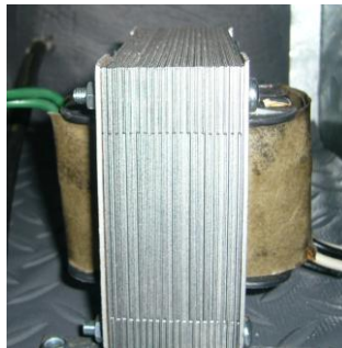
Figura 3.25 Transformador 110 a 12Vac
