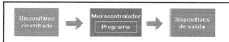
Figura 2-19. Diagrama de un sistema microcontrolado
