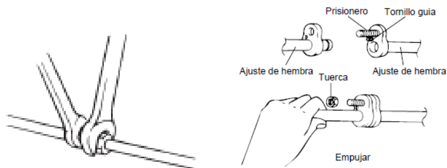
Fuente: CALEFACCIÓN, VENTILACIÓN Y AIRE ACONDICIONADO; Manual de servicio Hyundai Accent Figura 6.17: Precauciones al montar los elementos de conexión
