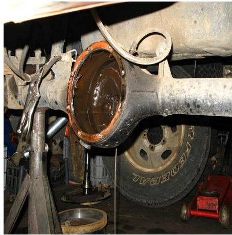
Figura2.7. Herrumbre en el sistema de transmisión.
