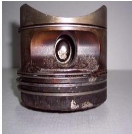
Figura 2.6. Corrosión en pistón.
