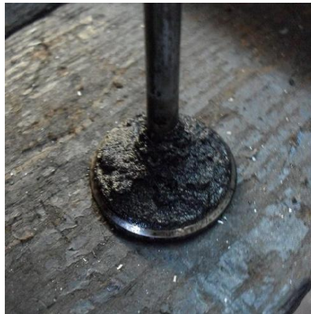
Figura 2.8. Residuos carbonosos en válvulas.
