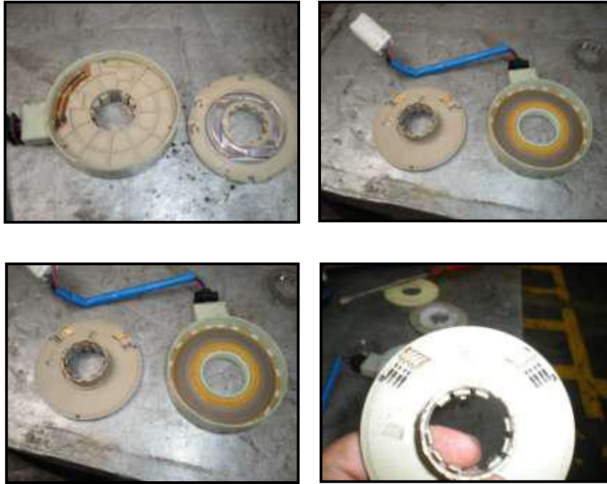
Figura 2.34. Desmontaje del sensor de torque
