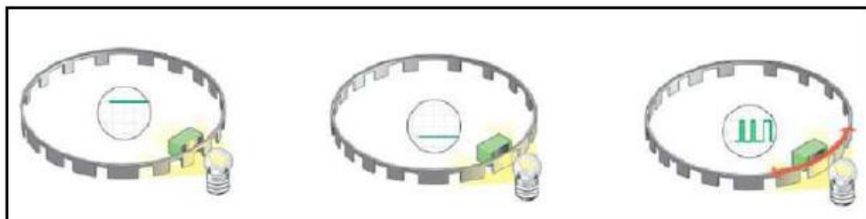
Figura 2.3. Principio de funcionamiento del sensor de ángulo
