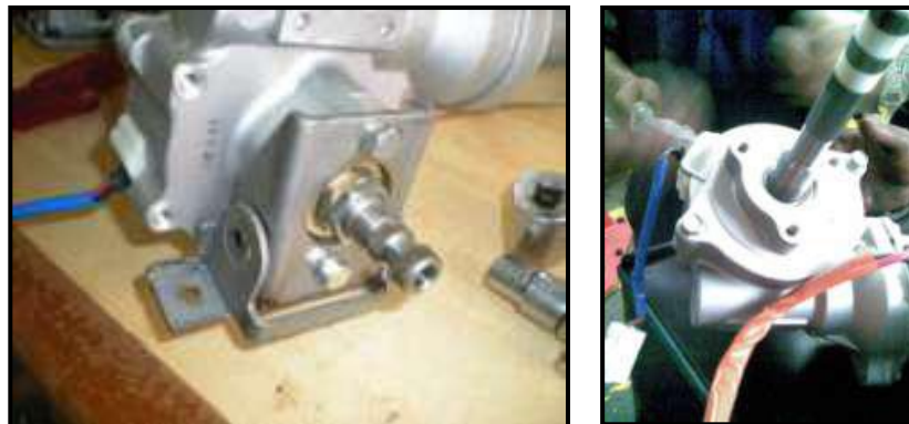
Figura 2.31. Desmontaje de la carcasa
