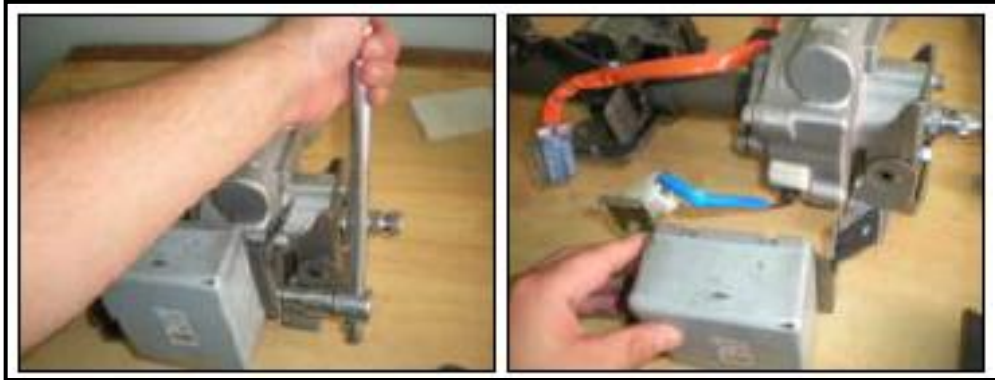
Figura 2.30. Desmontaje de la EPSCM
