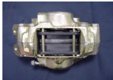
Figura 3.18: Pinzas de pistón opuesto
