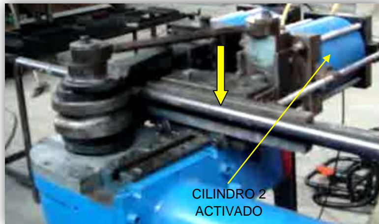
Figura 4.11.- Sujeción óptima del tubo tras la activación del cilindro 2.
