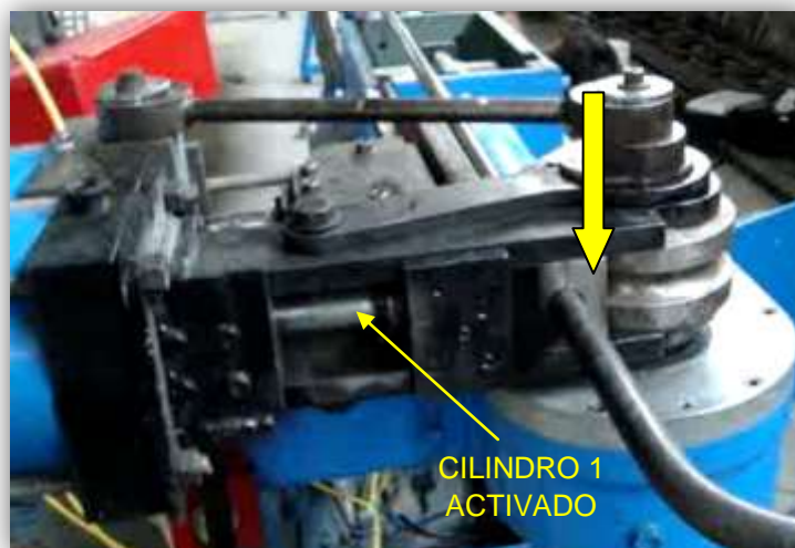
Figura 4.10.- Sujeción óptima del tubo tras la activación del cilindro 1.
