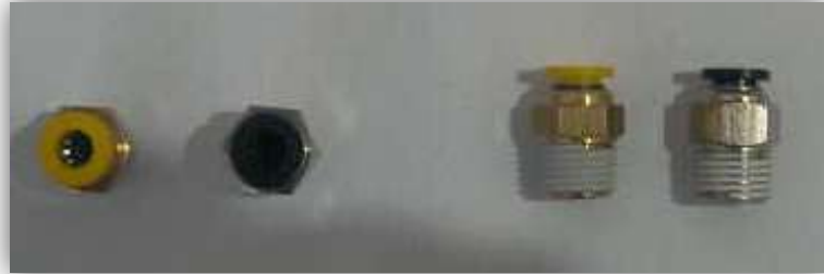
Figura 2.40.- Acoples rápidos de \frac{1}{4} "a 6 mm.
