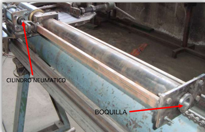
Figura 2.42.- Accionamiento mecánico de la boquilla.
