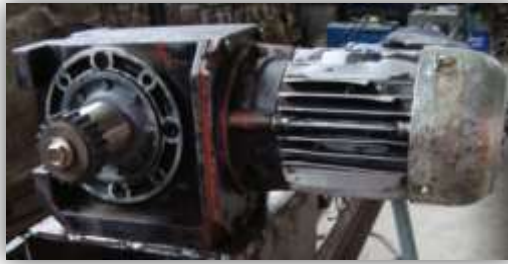
Figura 2.45.- Motorreductor extraído del reciclaje.
