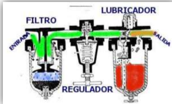
Figura 1.23.- Unidad de mantenimiento.
