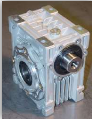
Figura 1.25.- Motorreductor sin fin – corona.
