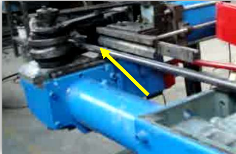
Figura 4.6.- Tubo desalineado respecto de la “Torta”.
