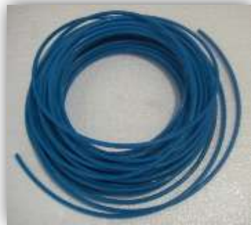
Figura 2.41.- Manguera neumática de 6 mm.
