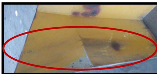
**Figura 5.30: Desgaste de la parte interior del apero.**
