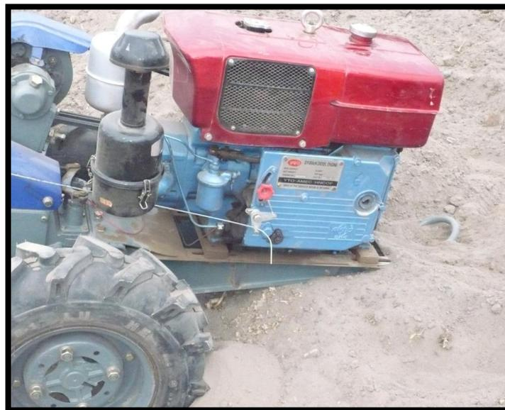
**Figura 5.3: Parte frontal del motocultor clavado por causa del primer apero construido.**
