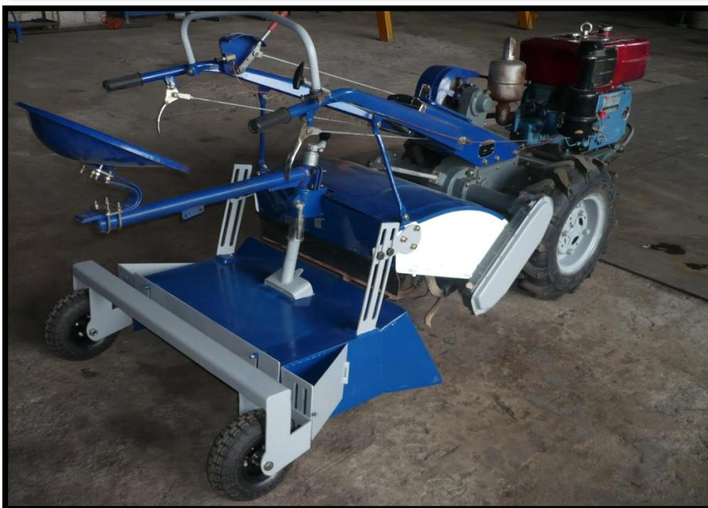
**Figura 4.84: Vistas isométricas de la construcción del ensamblaje completo de nuestro motocultor formador de camas de cultivo.**
