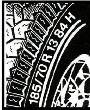
**Figura 3.23: Identificación de la cubierta neumática.**
