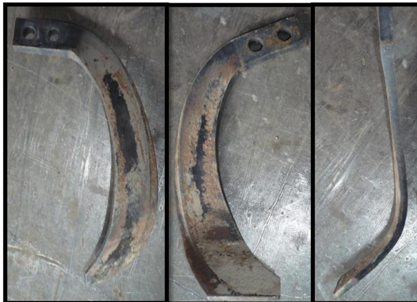
**Figura 5.33: Desgaste de las cuchillas después de las pruebas.**
