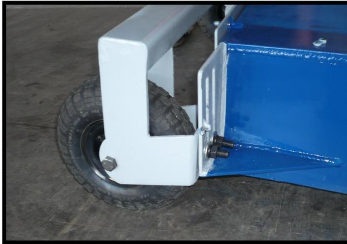
**Figura 5.6: Sistema de regulación de altura de las ruedas.**
