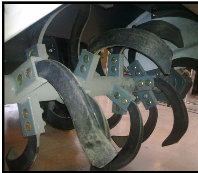
**Figura 5.32: Estado de las cuchillas sin uso.**
