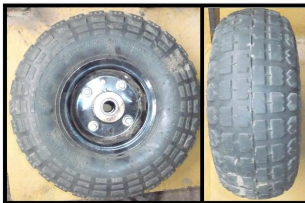
**Figura 5.35: Estado actual de las ruedas de la camadora después de las pruebas.**
