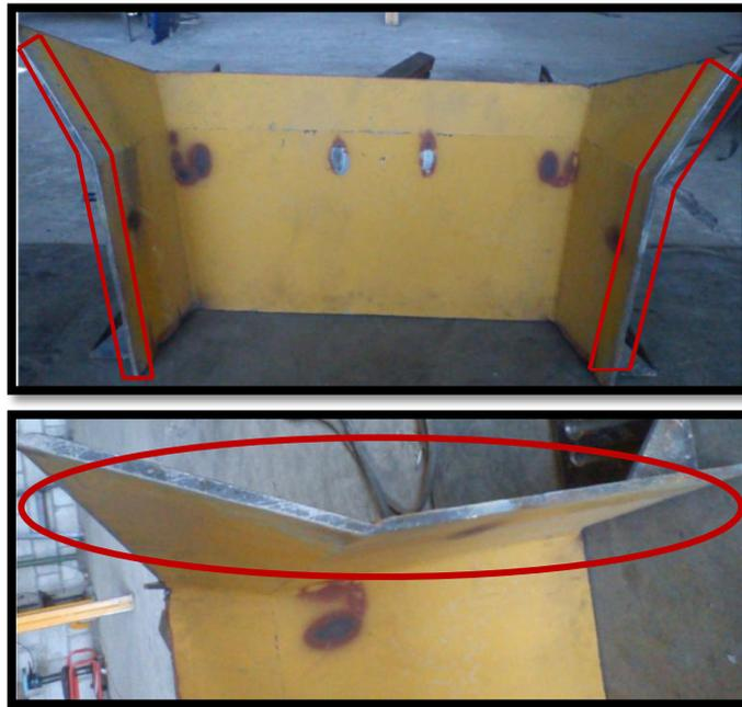
**Figura 5.29: Desgaste de la parte inferior del apero.**
