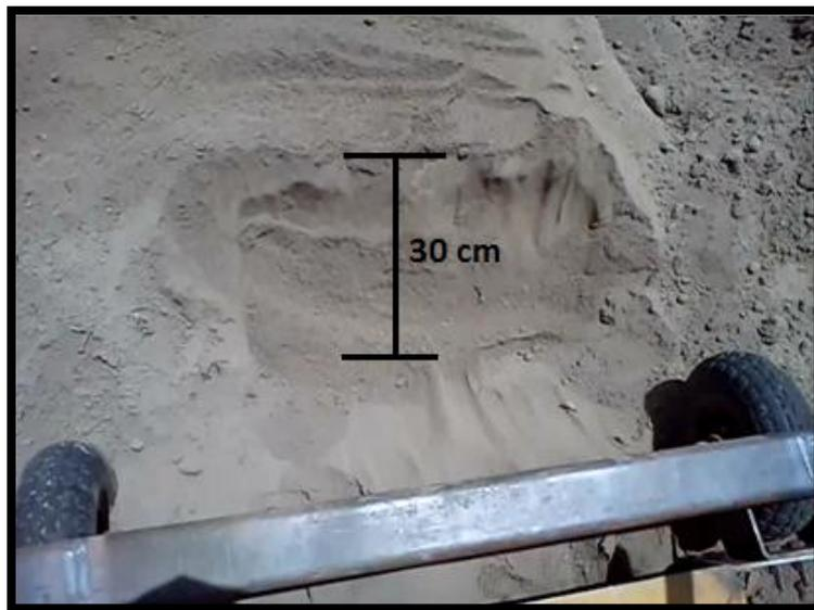
**Figura 5.23: Pruebas de profundidad de labranza de las cuchillas del rotocultivador.**
