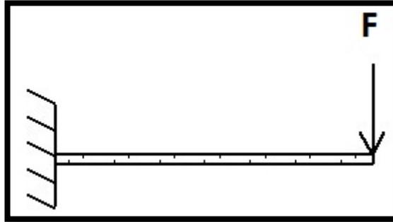
**Figura 4.11: Diagrama de cuerpo libre de la placa sin nervadura.**
