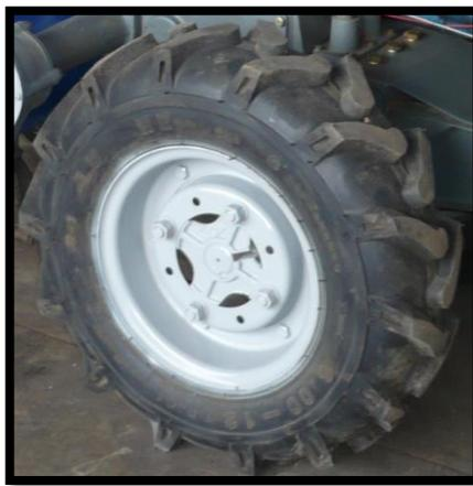
**Figura 5.34: Estado actual de las ruedas del motocultor después de las pruebas.**
