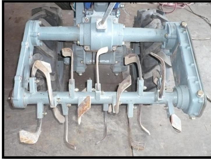
**Figura 5.26: Segunda disposición de las cuchillas.**
