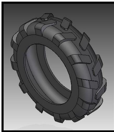
**Figura 4.50: Modelado del neumático con cubierta de garra normal tipo R-1.**
