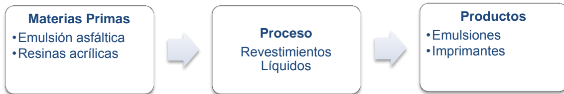
Figura 3.3 Proceso revestimientos líquidos
