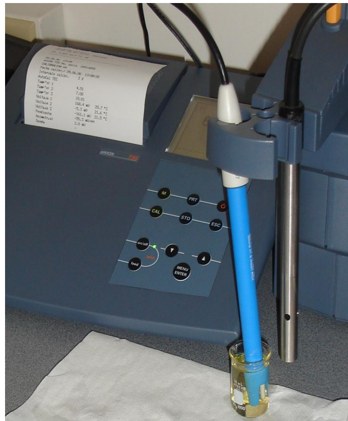
Gráfico 3.7 Peachímetro con el electrodo introducido en Aceite Esencial
