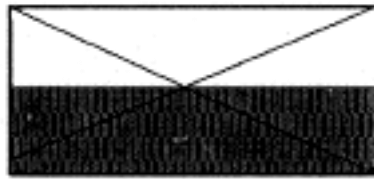
Gráfico 3.5 Campo Ocular del Refractómetro
