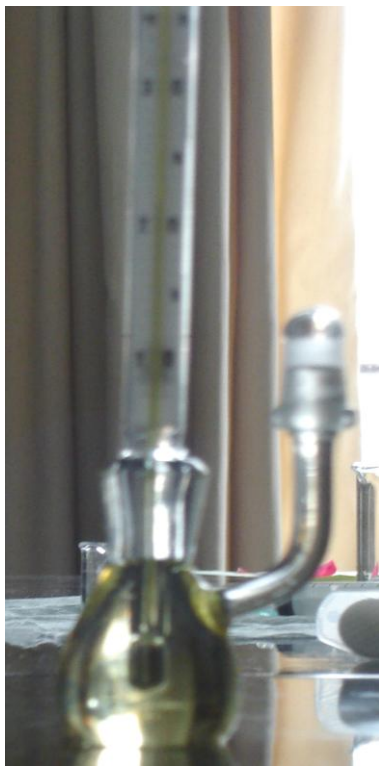
Gráfico 3.3 Picnómetro de 10ml con Aceite Esencial (20°C)
