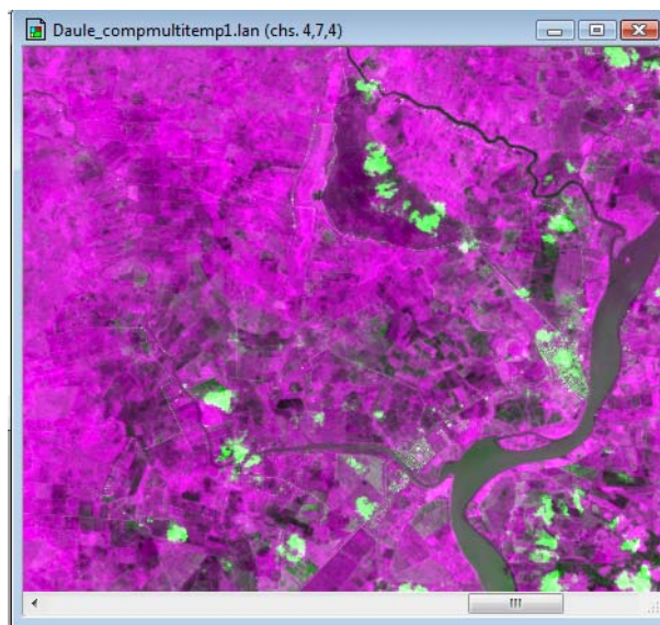
Figura 4.13. Imagen resultante de la aplicación detección de cambios de la cobertura vegetal
