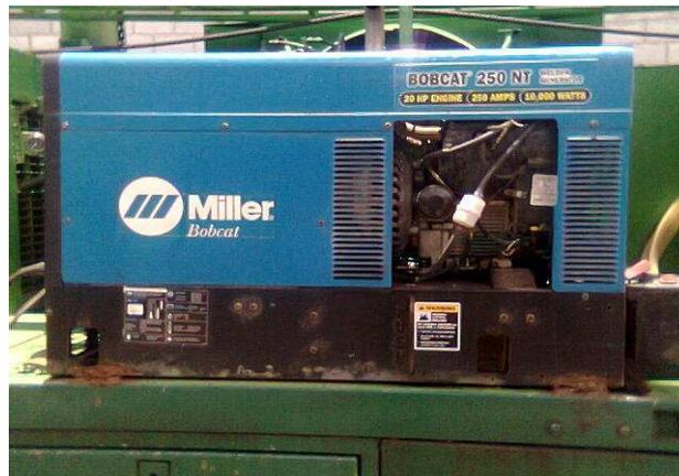
Figura 4.113. Máquina de soldadura SMAW
