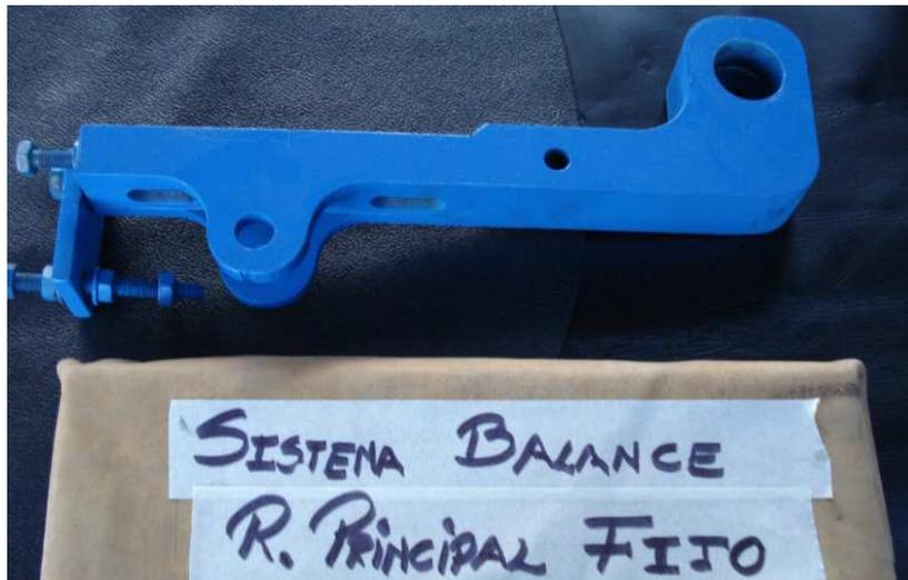
Fig. 4.56. Pieza para sistema de balanceo rodillo principal fijo
