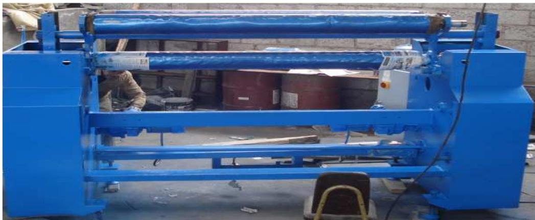
**Fig. 4.17. Ensamble bastidor de la máquina**
