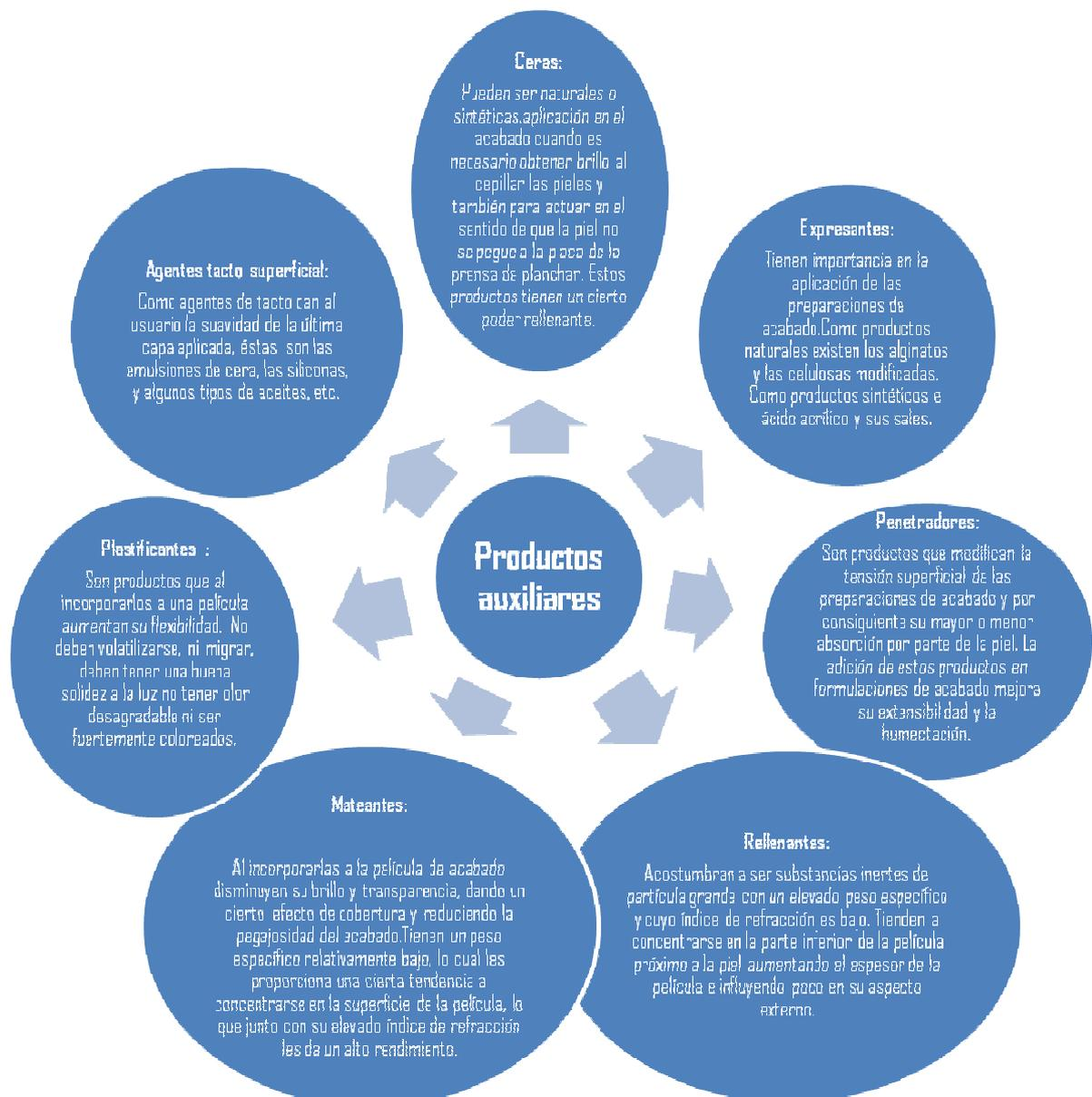
Figura 2.3. Productos auxiliares en el terminado
