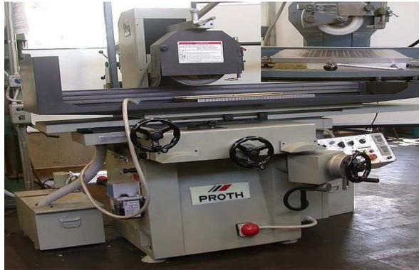
**Figura 4.119. Rectificadora de superficies planas**
