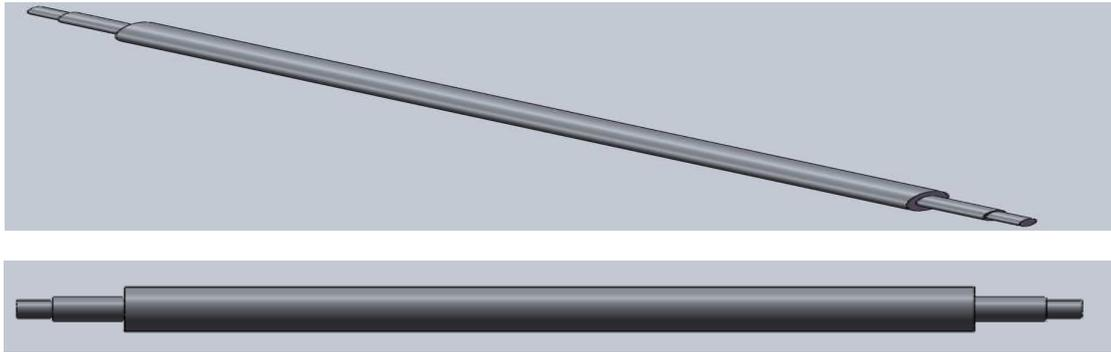
**Fig. 4.70. Esquema rodillo tensor del tapete**
