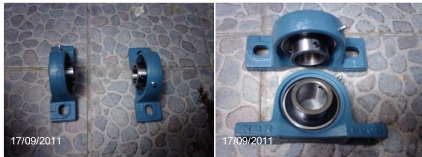
Fig. 4.7 Fotografías de chumaceras a utilizarse para el giro.
