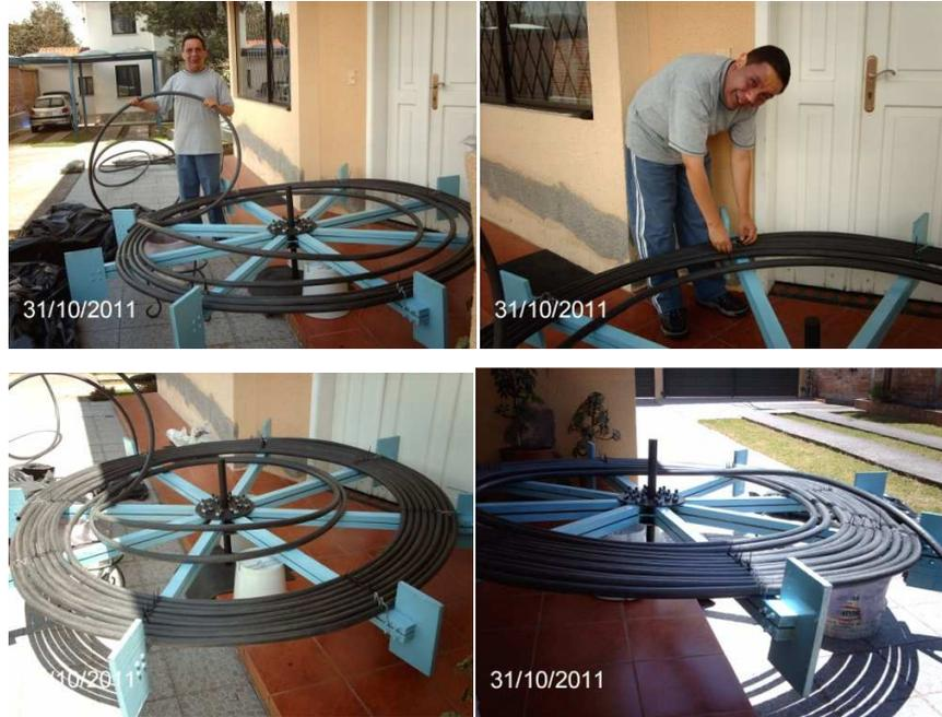
Fig. 4.13 Fotografías de colocado de espiral manguera de 1"
