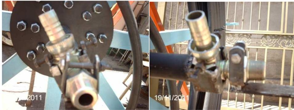
Fig. 4.18 Fotografías de acople articulación hidráulico y elementos de sujeción montado en el banco de pruebas
