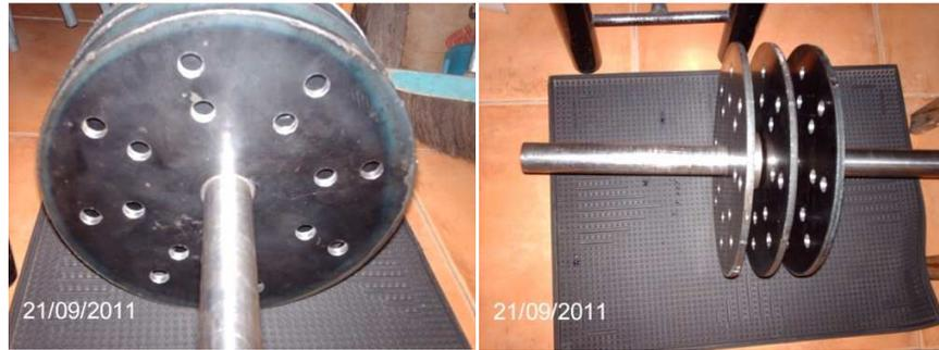
Fig. 4.3 Fotografías de placas agujereadas y colocadas correctamente en el eje.
