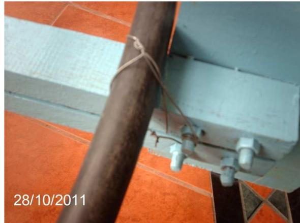
Fig. 4.11 Fotografía de sujeción de la primera espira con alambre galvanizado que envuelve la manguera con el radio y a un perno de las paletas
