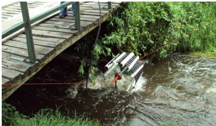
Fig. 1.3 Bomba de espiral en pruebas realizadas en el río Pita el 20/10/2010
