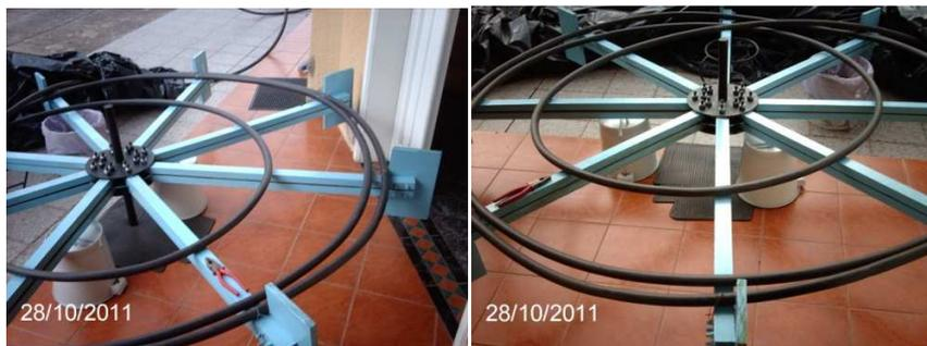
Fig. 4.10 Fotografías de inicio de espiralado de la manguera.
