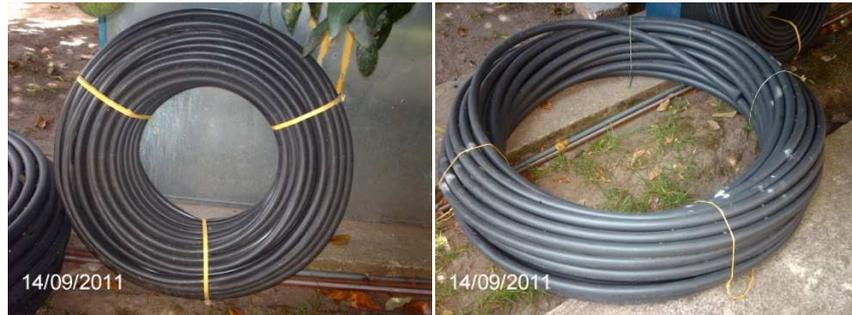
Fig. 4.9 Fotografías de mangueras de polietileno de 3/4" y de 1" utilizadas para las espiras
