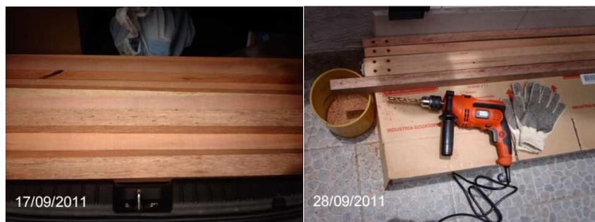
Fig. 4.4 Fotografías de los radios de madera colorado cortados, y durante el proceso de taladrado de los agujeros.
