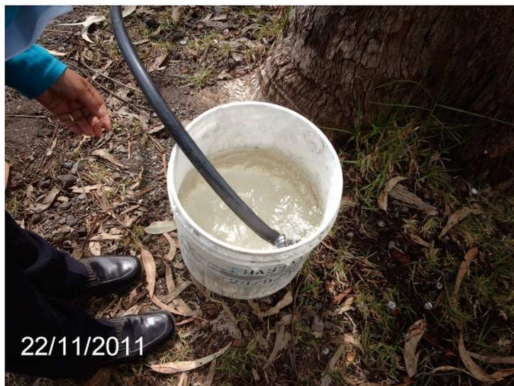
Fig. 5.1 Fotografía de Caneca de 20 litros utilizada para medir el caudal
