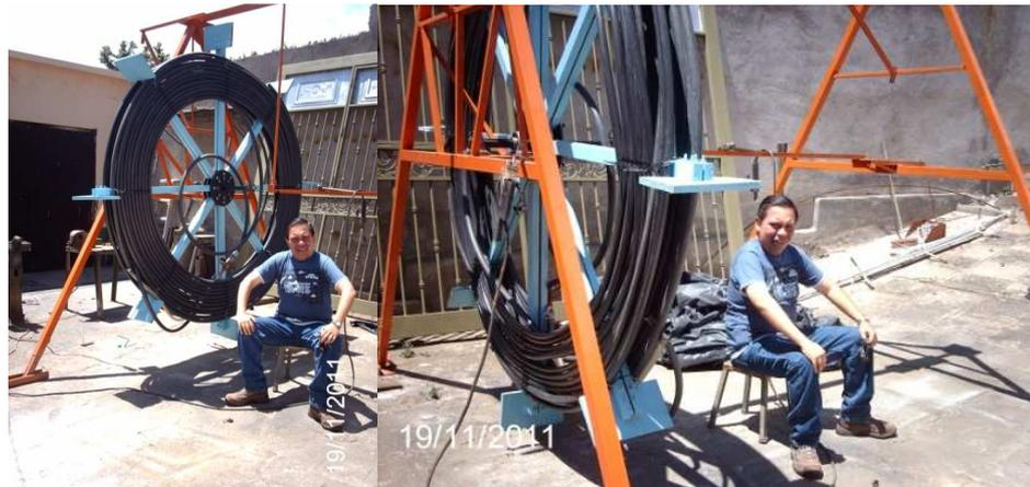
Fig. 4.19 Fotografías de estructura de soporte sujetando la rueda de espiral.
