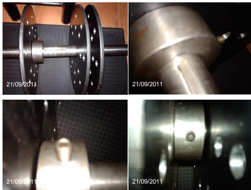
Fig. 4.2 Fotografías de chaveta, manzana y prisionero a colocarse en eje junto con las placas
