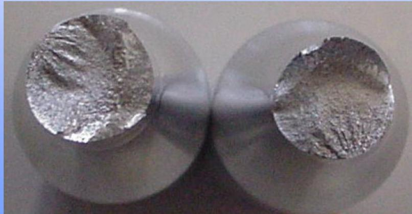
Fig1.3: Superficie de rotura por fatiga.
