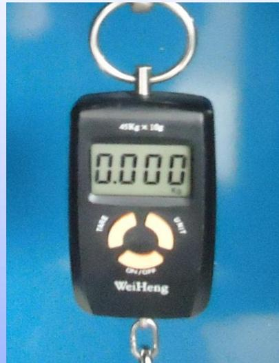
En su interior cuenta con bandas extensométricas resistentes al desgaste, que permiten obtener valores precisos, su rango de medición está comprendido entre 0 y 45 Kg con una buena resolución de centésimas.
