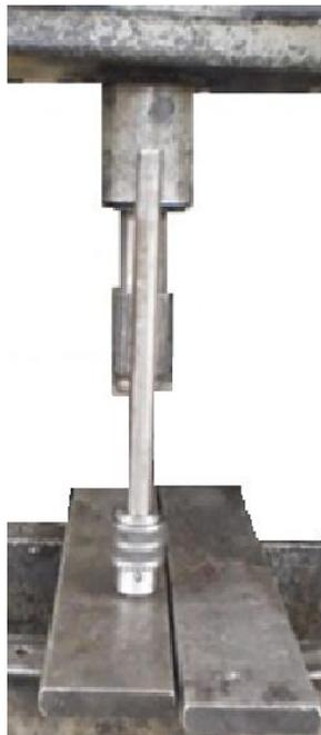
Figura 3.1. Montaje de los ejes en los mandriles.
