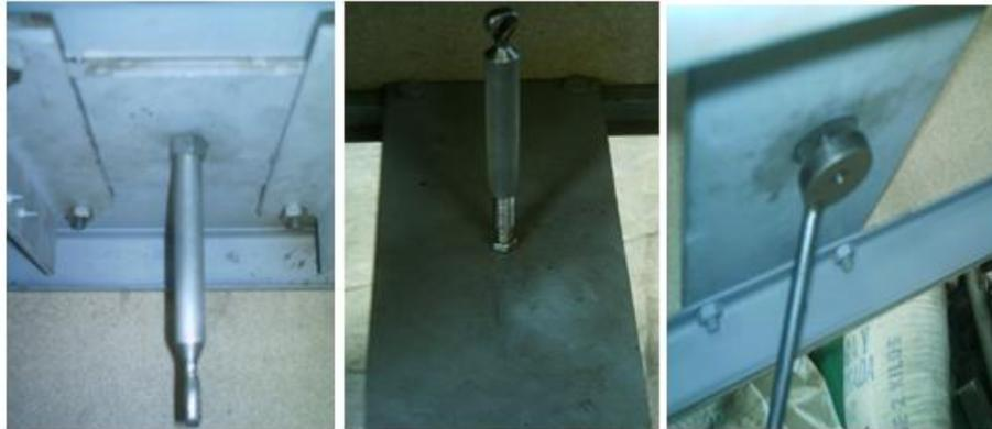
Figura 3.6. Montaje de la barra fija, barra móvil y manivela.
