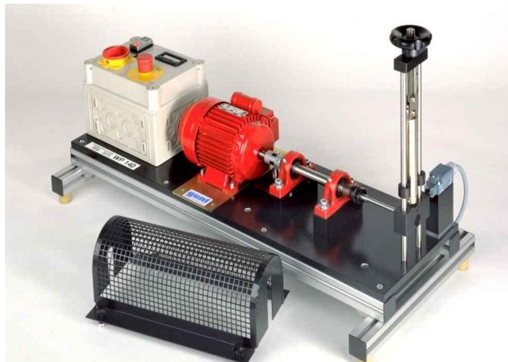
Figura 1.11. Máquina de flexión rotativa marca Gunt WP 140.<sup>18</sup>
