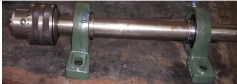
Figura 3.2. Montaje de los ejes con los rodamientos-chumaceras.
