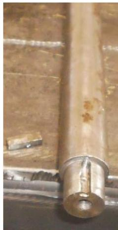
Figura 3.3. Montaje de la chaveta sobre el eje motriz.
