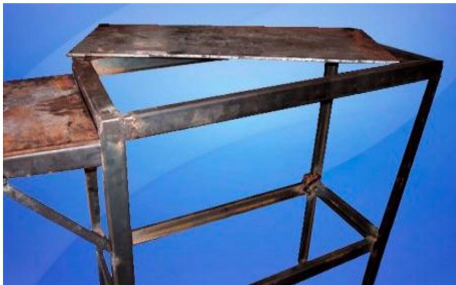
Figura 3.5. Montaje de la placa de soporte principal.
