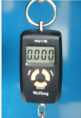
Figura 2.3. Dinamómetro Digital.
