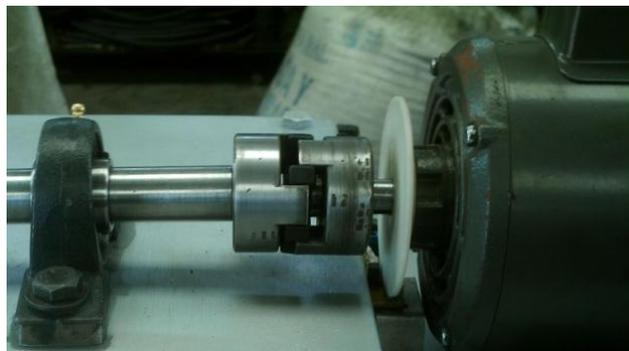
Figura 3.7. Montaje del motor en el eje de motriz.
