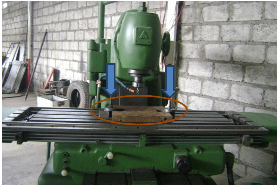
Figura 5: Colocación de material
