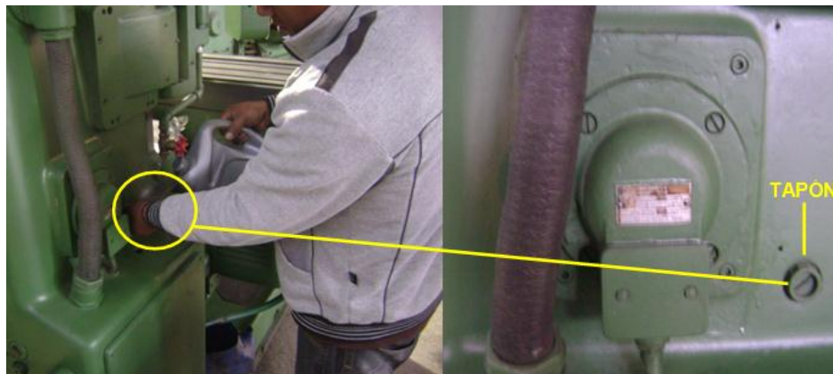
Figura 4.101: Llenado de aceite en los componentes principales
