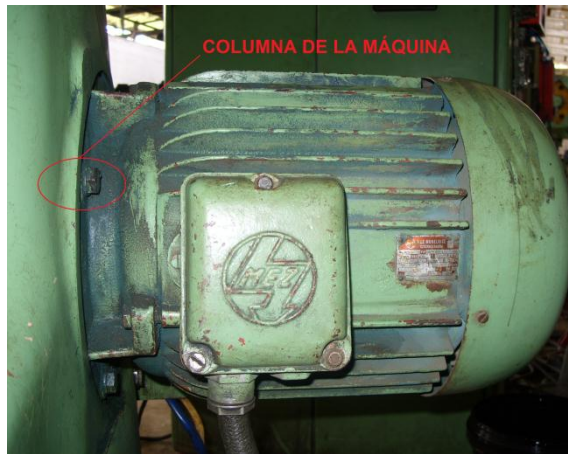
Figura 4.7: Motor montado en la columna de la máquina
