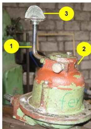
Figura 4.15: Parte posterior de la bomba hidráulica; 1 Succión, 2 Descarga, 3 Filtro
