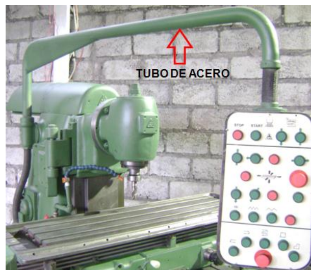
Figura 4.28: Tubo de acero montado en la fresadora
