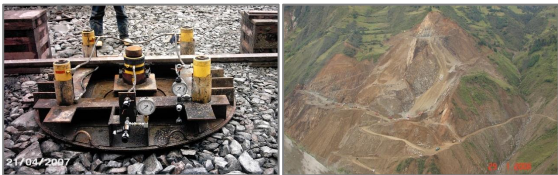
Figura 2.84: a) Equipo para prueba de placa, b) Canteras La Bola e Ingapata (Fuente: Caminosca, 2011)
