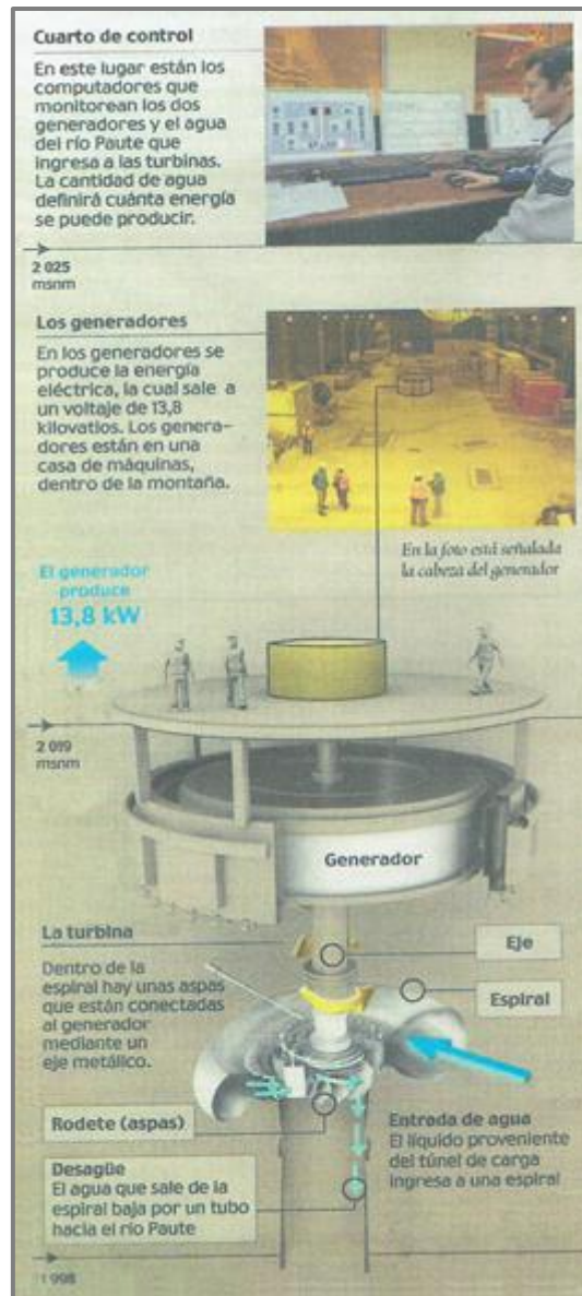
Figura 2.14: Niveles de la casa de máquinas (Fuente: Diario El Comercio, 06/06/2010)
