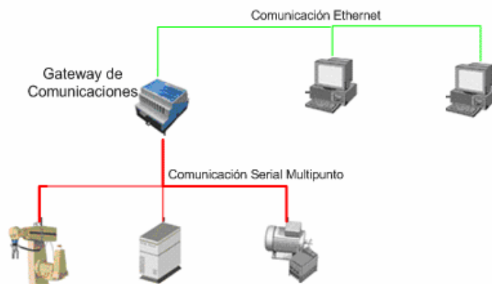
Grafico 1.9. Diagrama Serial-Ethernet en base a pasarelas propietarios.
