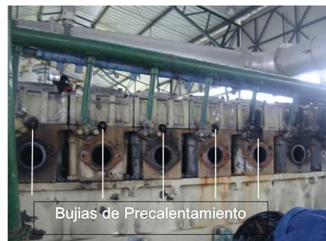
FIGURA 5.27 Ubicación de las Bujías de Precalentamiento
