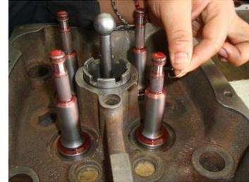
FIGURA 3.46 Armado de Válvulas
