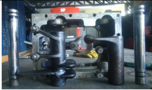
FIGURA 3.2 Componentes de la Caja de Balancines
