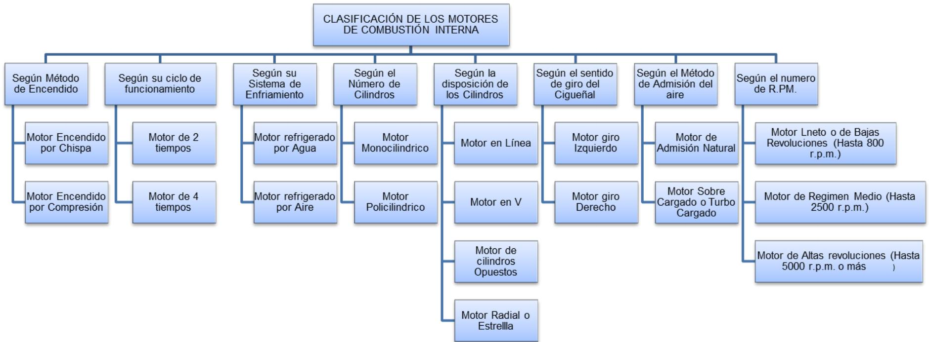
FIGURA 2.2 Clasificación de los Motores de Combustión Interna
