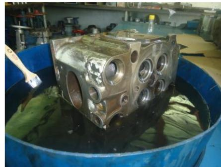
FIGURA 3.14 Limpieza de Culatas con Diesel
