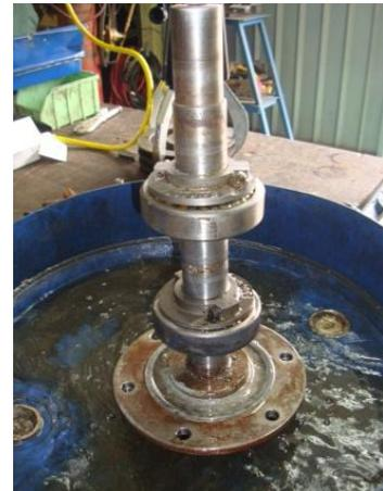
FIGURA 3.120 Eje del Ventilador
