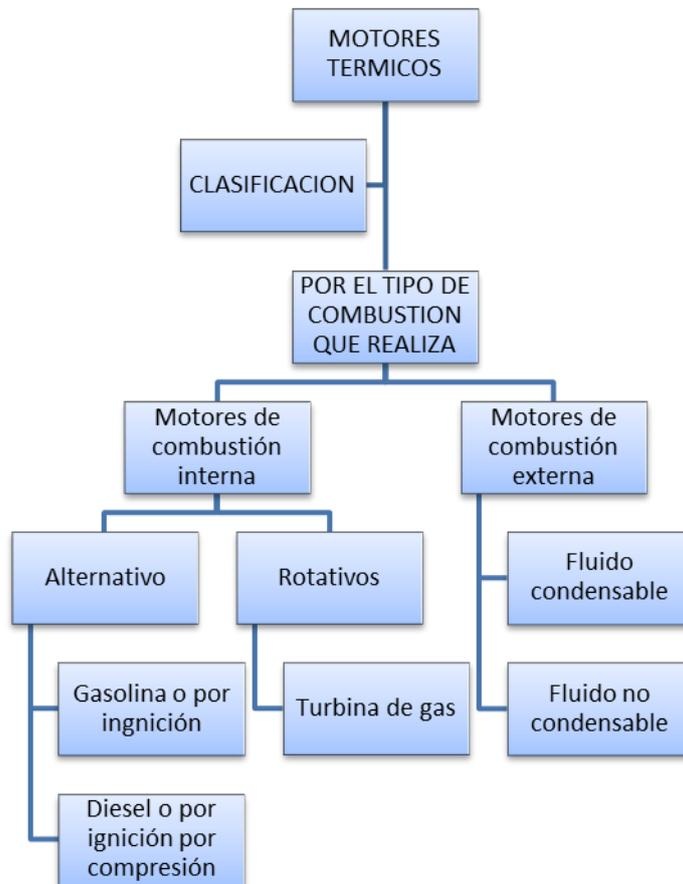
FIGURA 2.1 Clasificación de las Máquinas Térmicas.
