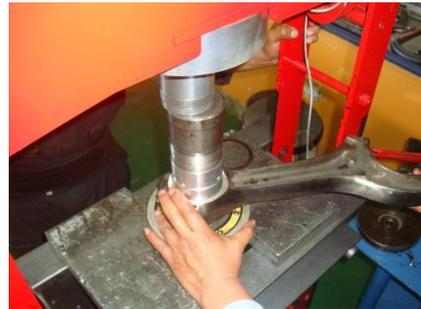
Figura 3.66 Armado de cojinetes de Bulón.
