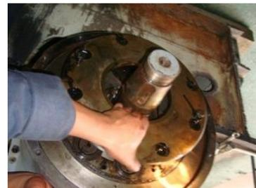
FIGURA 3.107 Limpieza del Amortiguador de Vibraciones
