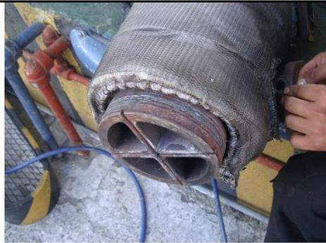
FIGURA 3.117 Armado de los empaques en la conexión con el Turbo
