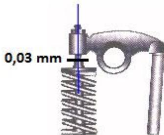
FIGURA 5.9 Calibración de los Balancines
