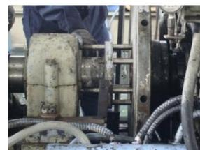
FIGURA 5.11 Desarmado del Volante de Inercia
