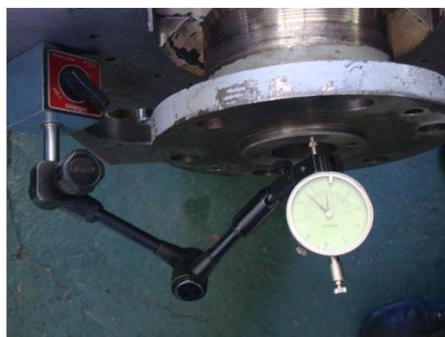
FIGURA 5.3 Calibración Juego Axial
