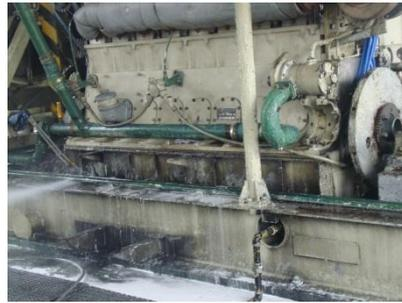
FIGURA 5.16 Limpieza con agua después de la Remoción de la Pintura
