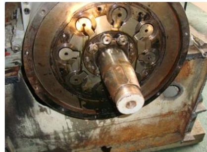
FIGURA 3.106 Amortiguador de Vibraciones
