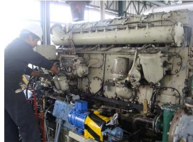
FIGURA 5.10 Desarmado de los componentes del Motor
