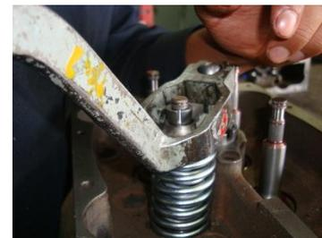
FIGURA 3.48 Armado de placas de resorte
