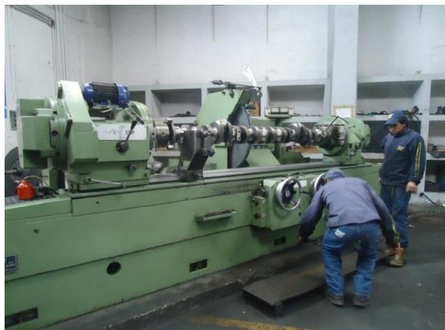
FIGURA 3.88 Mecanizado del Cigüeñal
