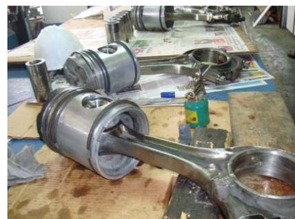
FIGURA 3.77 Armado de los componentes del Pistón
