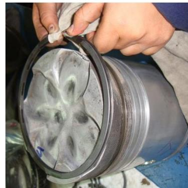
FIGURA 3.76 Armado de los Anillos de Pistón
