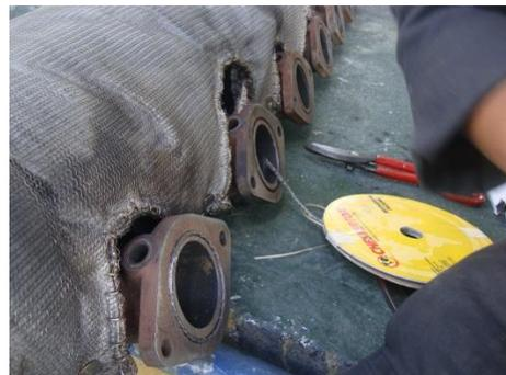
FIGURA 3.316 Armado de los empaques.
