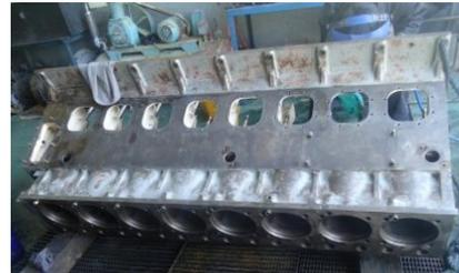
FIGURA 3.95 Bloque con removedor de Pintura
