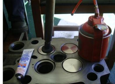
FIGURA 3.43 Proceso de Asentamiento de Válvulas
