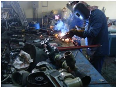
FIGURA 5.24 Proceso de Soldadura- Tubería de Aceite
