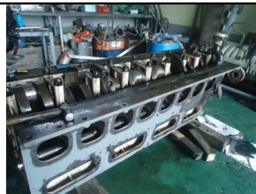
FIGURA 3.86 Desarmado del Cigüeñal
