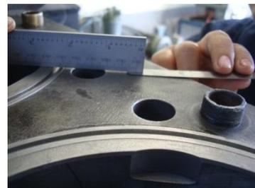
FIGURA 5.5 Calibración de la altura de la camisa
