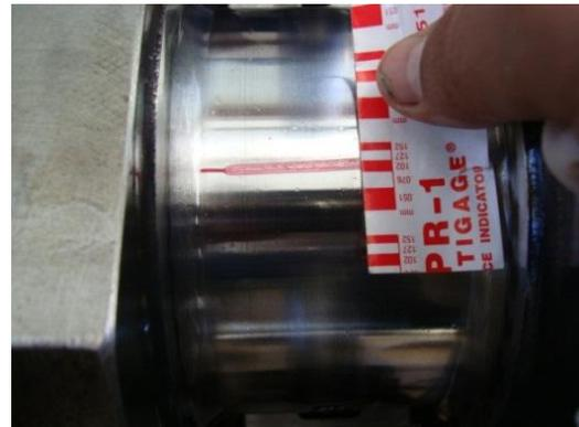
FIGURA 5.2 Calibración con Plastigage
