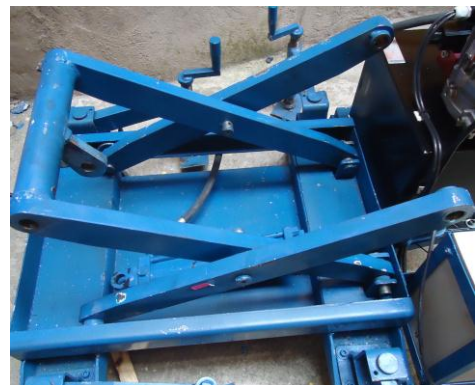
Figura 4.21: Montaje del primer segmento de tijeras.
