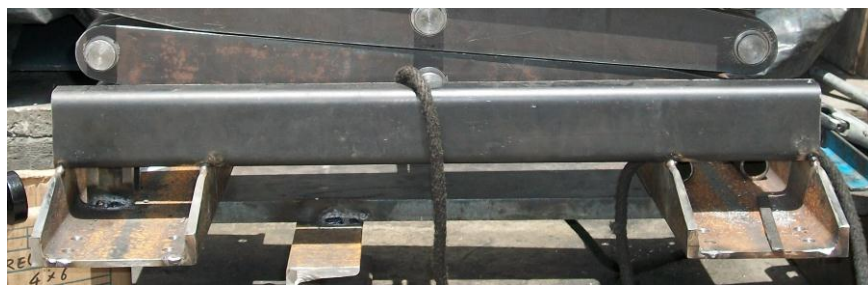
Figura 4.7: Plataforma del elevador
