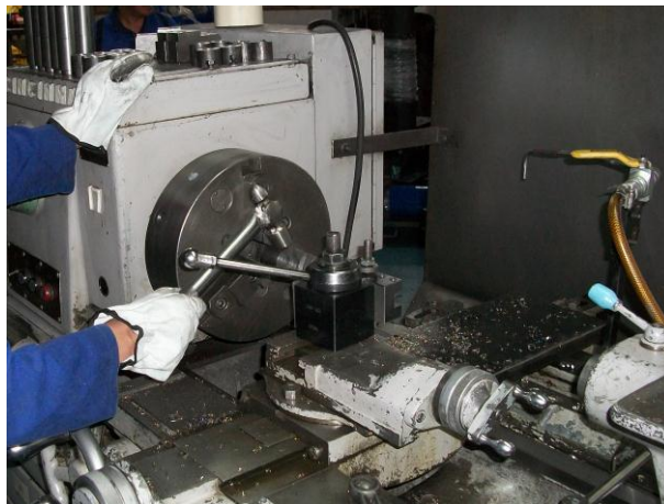
Figura 4.1: Fabricación de pasadores y bocines
