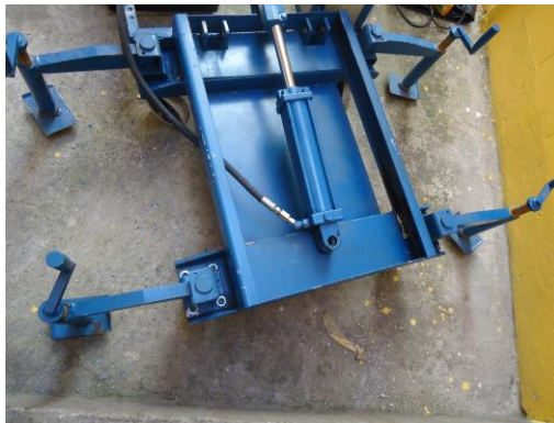
Figura 4.20: Montaje de ruedas estabilizadores en la estructura soporte.
