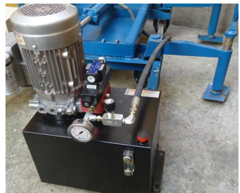
Figura 4.27: Montaje del conjunto bomba-motor
