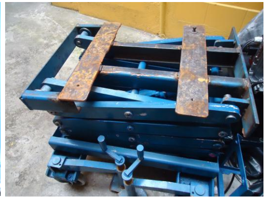
Figura 4.25: Montaje de plataforma superior
