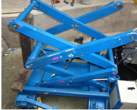
Figura 4.22: Montaje del segundo segmento de tijeras
